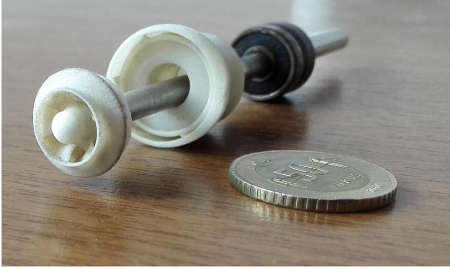
Şekil 10. Lazer sinterleme teknolojisi ile üretilen çark ve difüzörün fotoğrafı Figure 10. Photo of the impeller and diffuser produced by laser sintering technology
