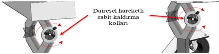
Şekil 12. Dairesel hareket yapan kaldırma kolları (Lifting arms with circular motion)
