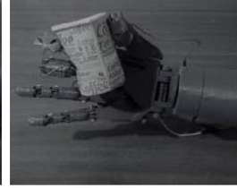
Şekil 16c. Robot ele hafif sık komutunun uygulanması
