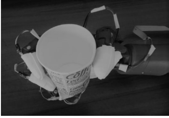
Resim 4.4. Robot el, hafif-tut (a) ve tut komutunu (b) uygulandığında robot el ve karton bardağın durumu
