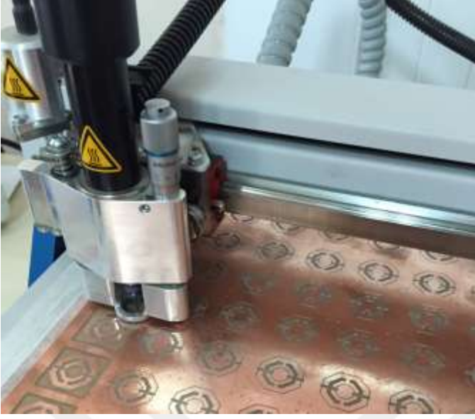
Şekil 3.3. LPKF-E33 protomat ile örnek bir üretim düzeneği
