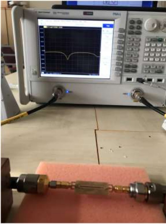
Şekil 3.2. Vektör ağ analizörü ve üretilen bir iletim hattı yapısı
