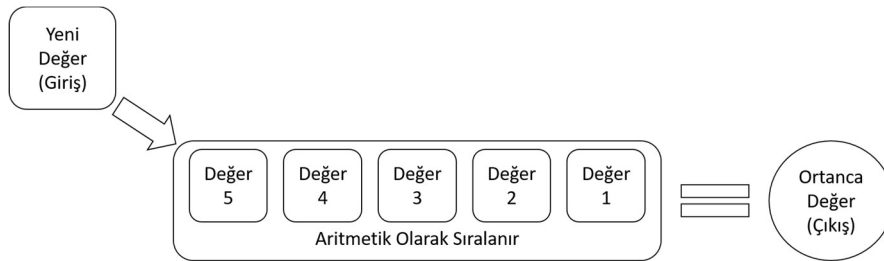
Şekil 2.3. Medyan filtre çalışma mantığı
