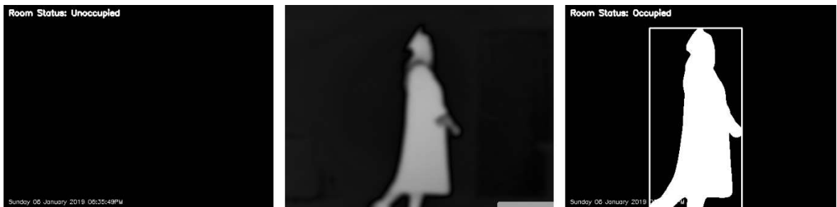
Resim 4.15. Hareket algılama algoritması ile hareketli nesne tespiti
