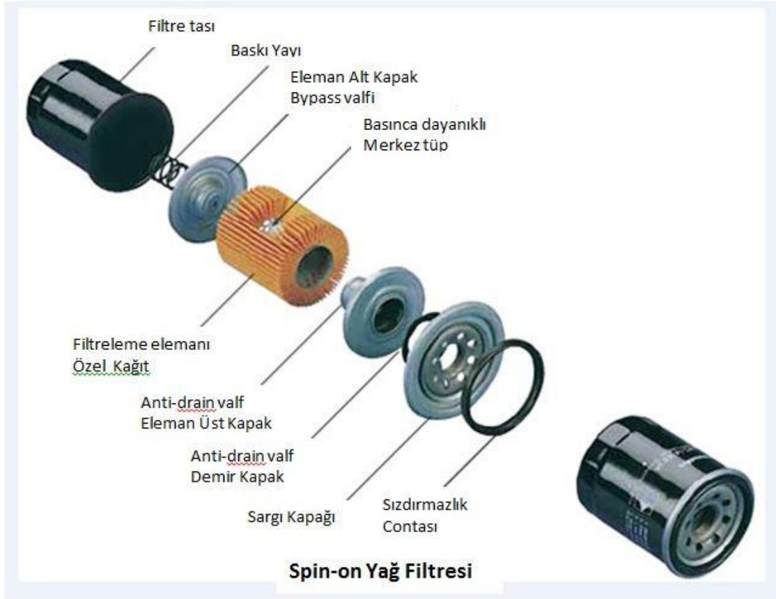
Şekil 3.3 Spin-on Tipi Yağ Filtresinin Elemanları [69]
