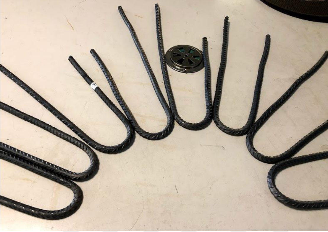
Resim 4.2. İleri-geri bükme yapılmış numune resimleri.
