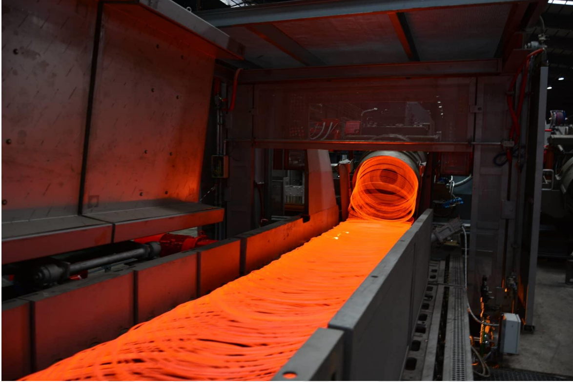
Resim 3.2. Filmaşın serme kafa ve konveyör sistemi.
