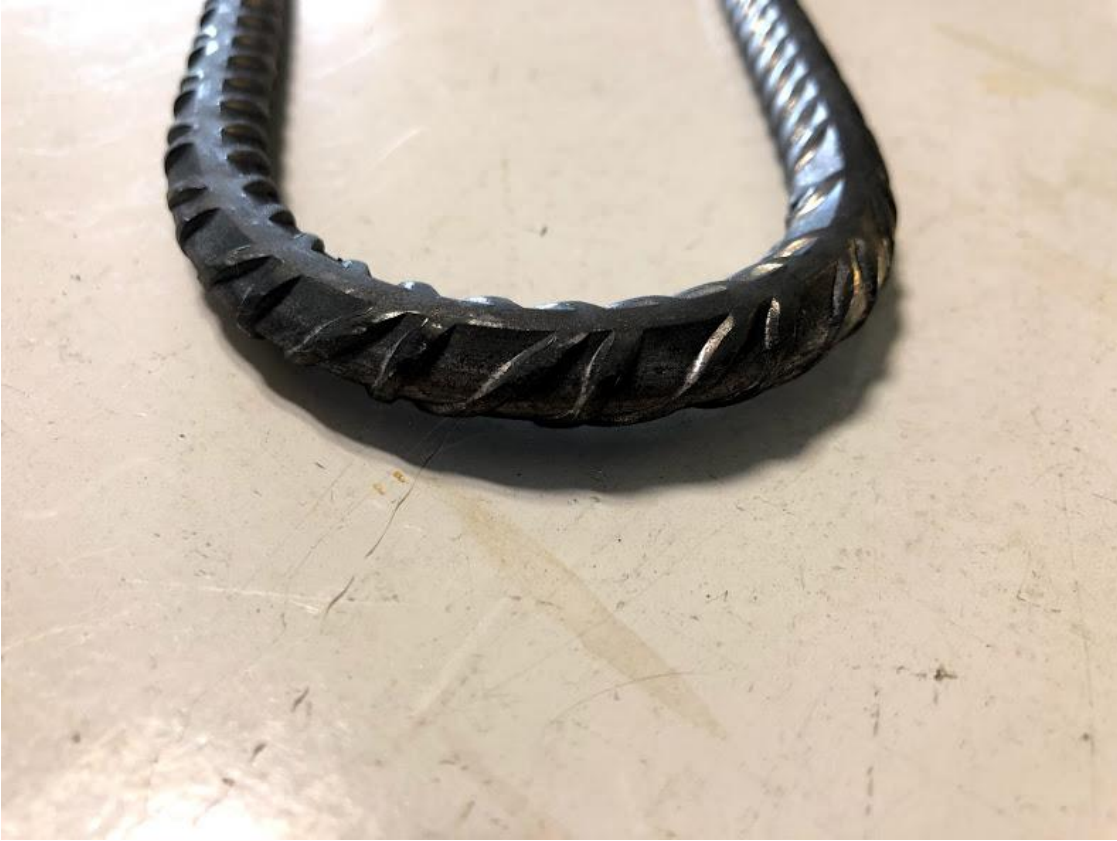
Resim 4.3. Çatlama olmadığını gösteren test numunesinin yakın çekim görüntüsü.
