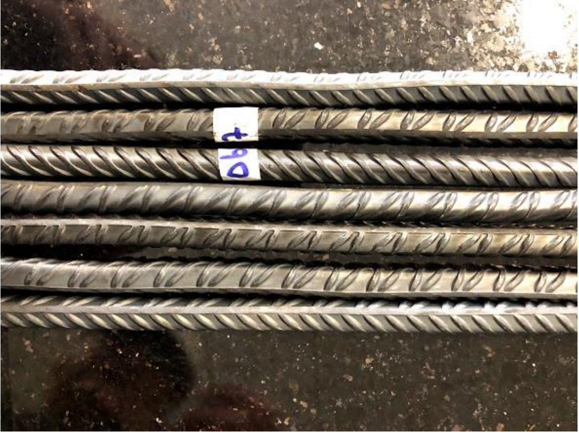
Resim 4.1. Doğrultma yapılmış numune resimleri.
