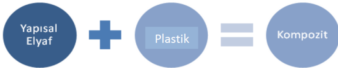
Resim 2.3 Elyaf takviyeli kompozit malzemenin oluşumu
