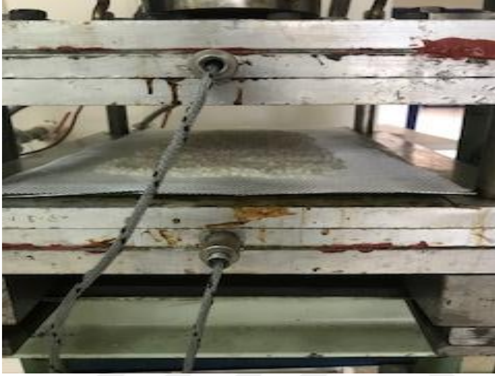
Resim 3.3. YYPE ve cam elyafın kalıba yerleştirilmesi
