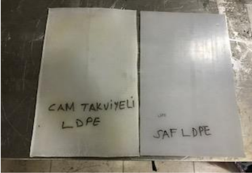
Resim 3.5. Saf DYPE ve cam elyaf takviyeli DYPE plakalar
