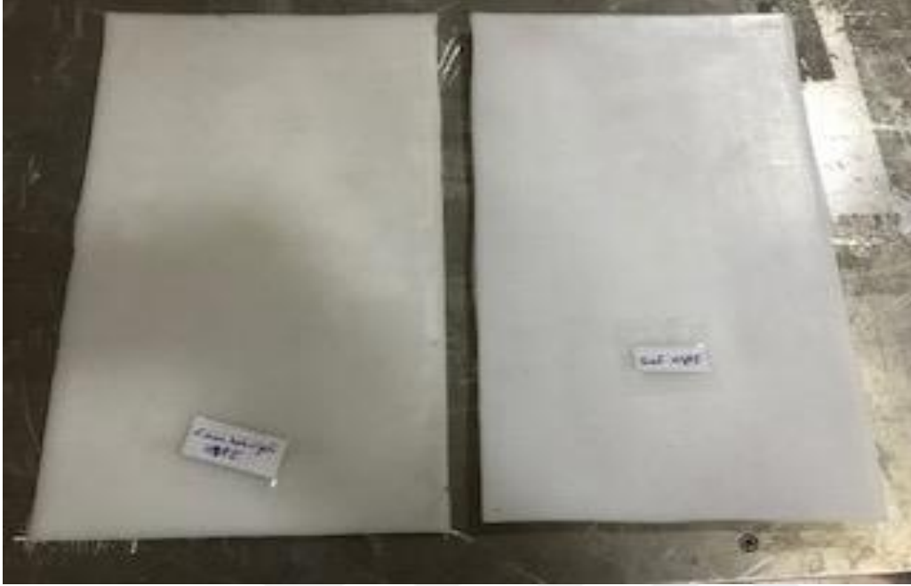
Resim 3.4. Saf YYPE ve cam elyaf takviyeli YYPE plakalar
