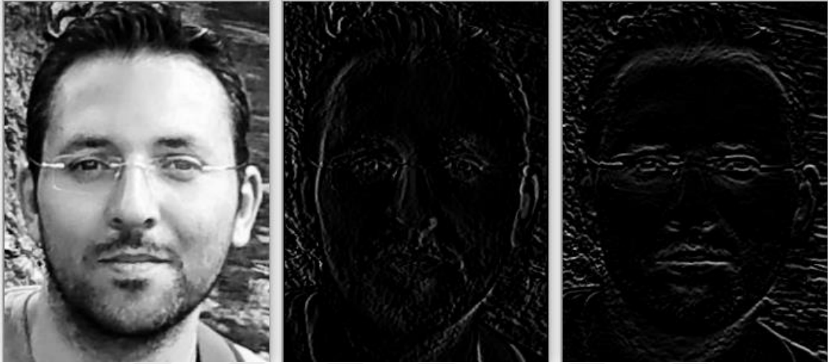
Resim 3.2. Orijinal görüntü (solda), x ekseninde gradyan görüntü (ortada), y ekseninde gradyan görüntü (sağda)
