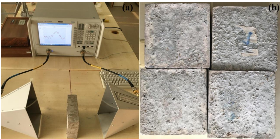
Şekil 4.48. Dielektrik ölçüm ortamı (a) ve hazırlanan inşaat malzemeleri (b)
