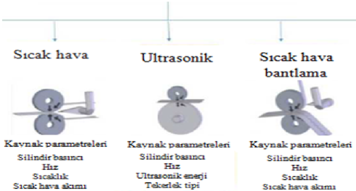
Şekil 3.4. Ultrasonik kaynak makinası ile birleştirme yöntemini şematik ve uygulama gösterim ( Manal, Mona, 2016).
