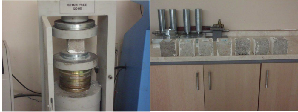
Şekil 3.3. Yığma duvar örme harcı numuneleri ve testleri
