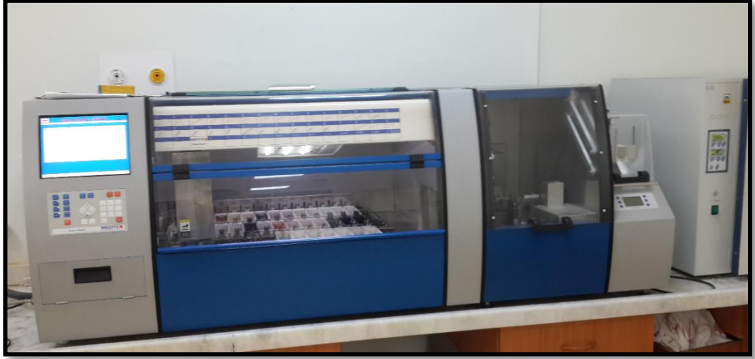
Şekil 3.5 Doku boyama cihazı ve doku kesitlerinin boyanması (orijinal)
