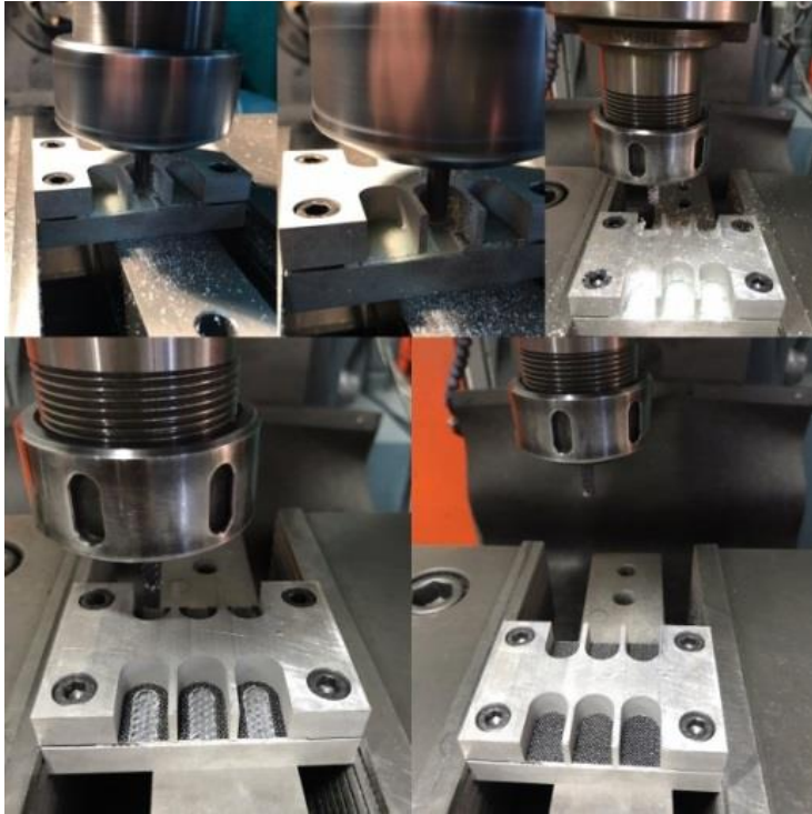
Resim 4.13. Arion-GEVS500A freze tezgahında yzey frezeleme iřlemi
