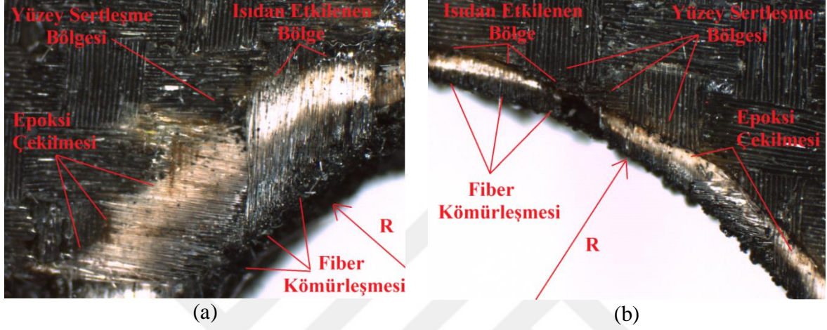
Resim 5.33. Lazer ışınının katkılı kompozit delik kenarına etkileri (a) Giriş yüzeyi (b) Çıkış yüzeyi
