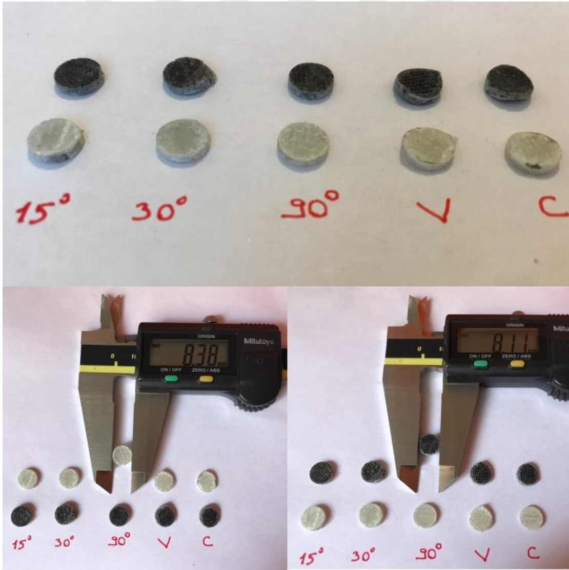
Resim 5.9. Farklı zımba profilleri ile kesilen pulların analizi
