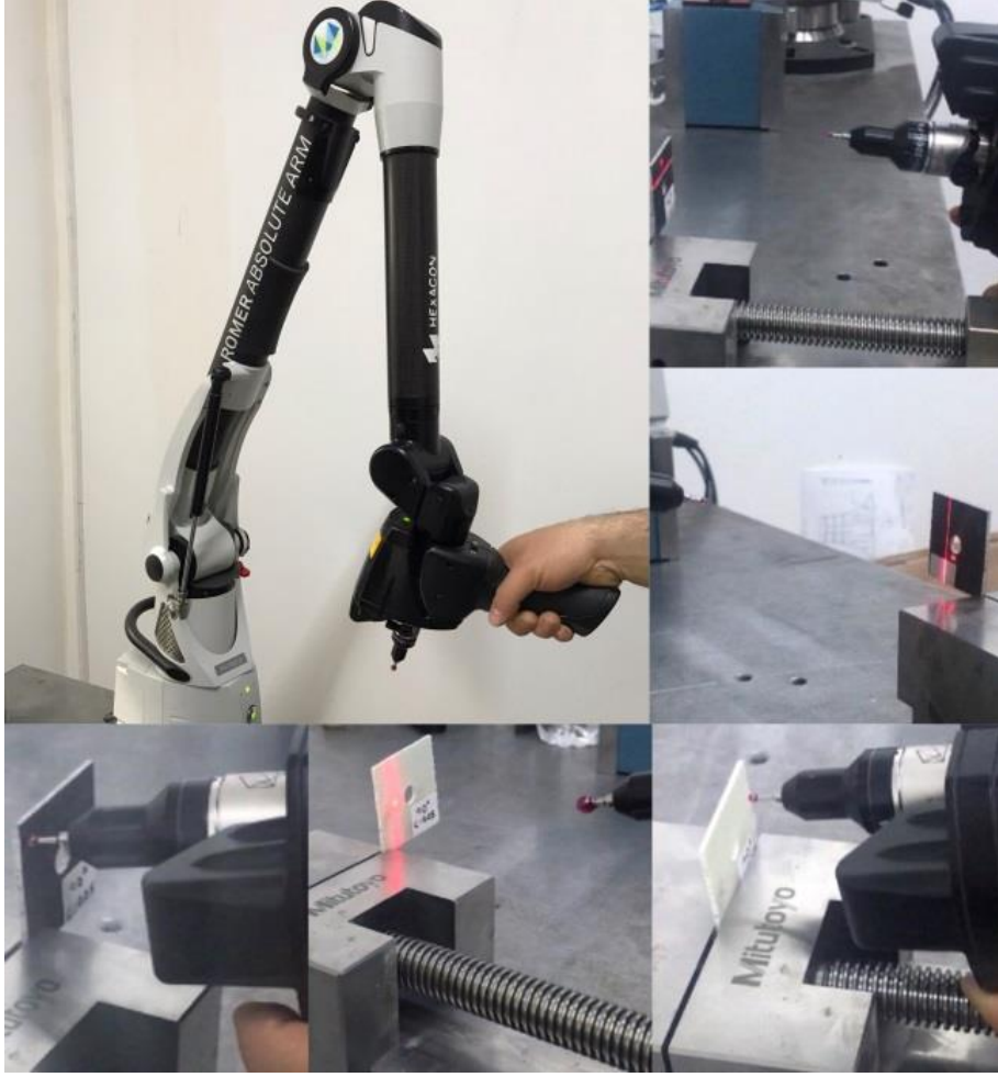
Resim 5.4. Romer Absolute Arm ile lazer tarama
