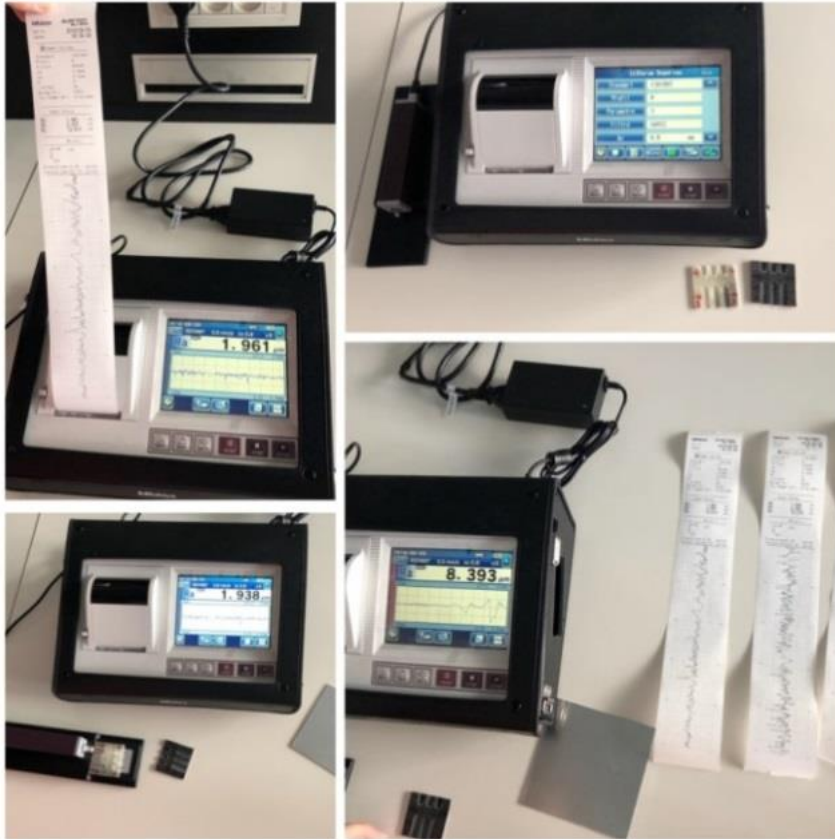
Resim 4.8. Surftest SJ-310 ile yüzey pürüzlülük ölçümü
