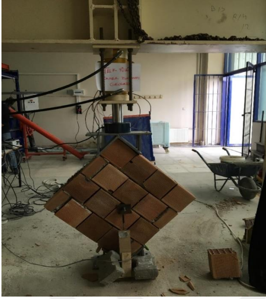
Resim 5.18. Diagonal yüklemeye hazır tek yüzü Tür 2 ile güçlendirilmiş 1. tuğla duvar numunesinin arka yüzü
