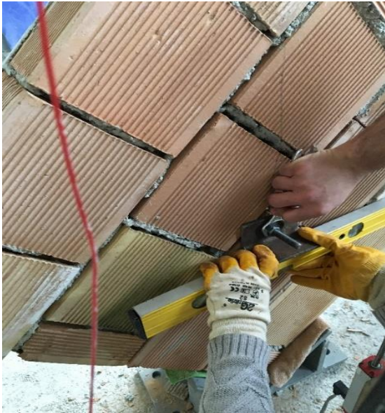
Resim 5.5. a) Tek yüzü Tür 1 ile güçlendirilmiş 1. tuğla duvarın diyagonal yükleme deneyine hazırlanması
