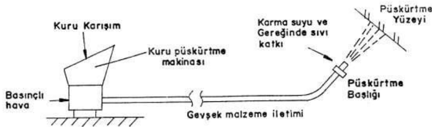
Şekil 2.17. Püskürtme betonu-kuru sistem (Bekişoğlu, 1993)
