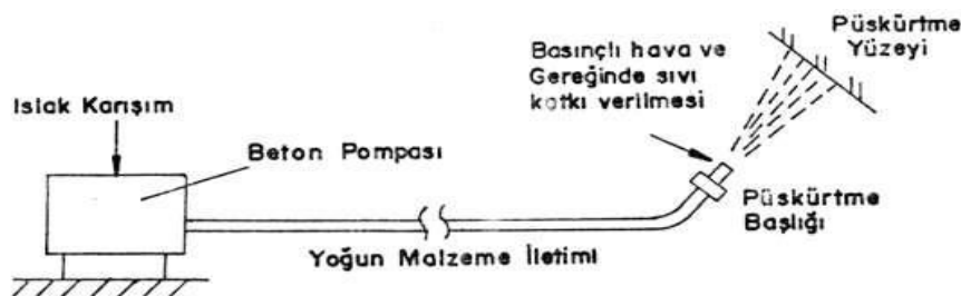
Şekil 2.18. Püskürtme betonu-ıslak sistem (Bekişoğlu, 1993)
