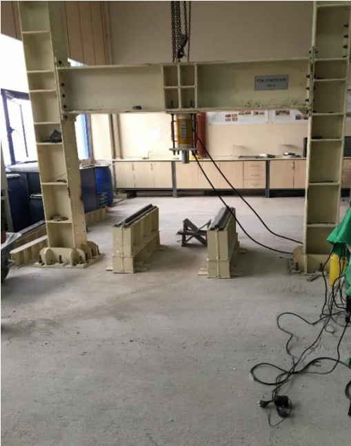
Resim 4.25. Diyagonal yükleme deneylerinin yapılacağı yükleme düzeneği
