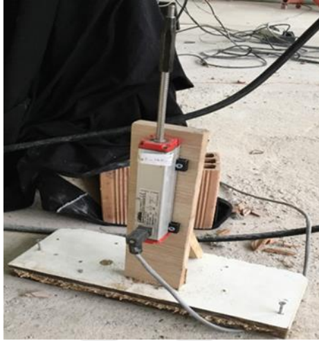
Resim 4.27. Deneysel ortamda kullanılan deplasman ölçer
