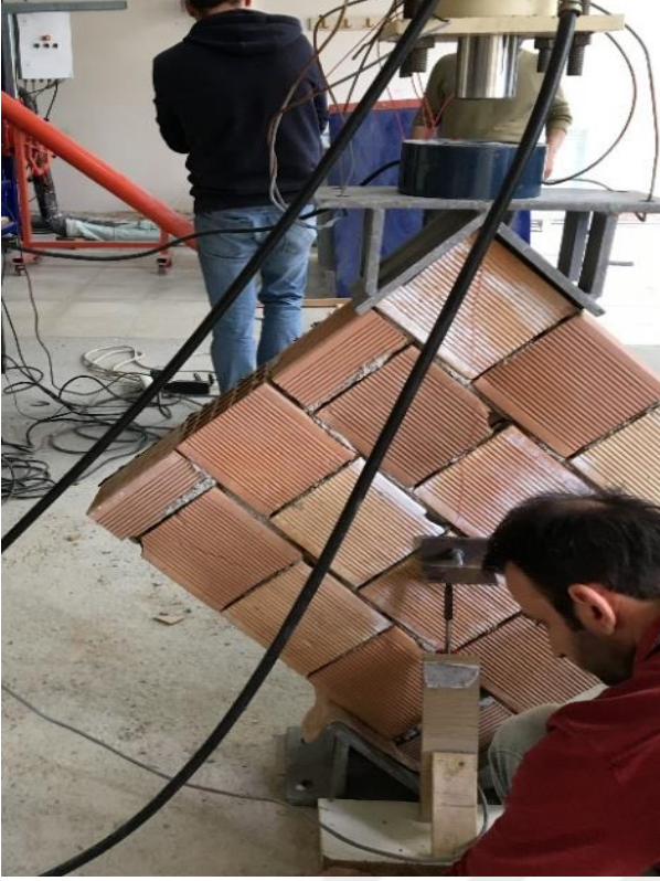
Resim 5.12. b) Tek yüzü Tür 1 ile güçlendirilmiş 2. tuğla duvar numunesin diyagonal yükleme deneyine hazırlanması
