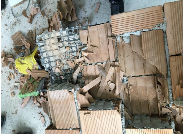
Resim 5.29. a) Diagonal yüklemeye deneyi sonrası tek yüzü Tür 2 ile güçlendirilmiş 2. tuğla duvar numunesi
