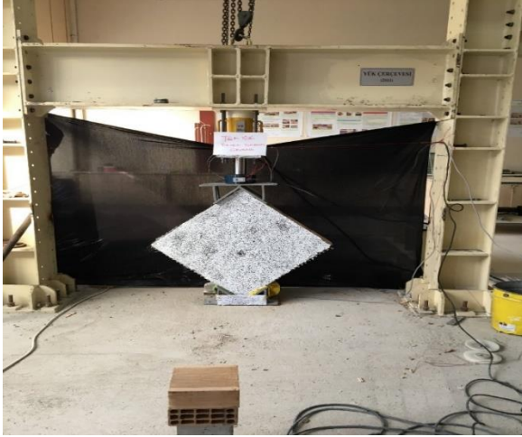
Resim 5.25. Diagonal yüklemeye hazır tek yüzü Tür 2 ile güçlendirilmiş 2. tuğla duvar numunesinin ön yüzü
