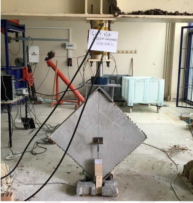
Resim 4.35. Yüklemeye hazır bir adet tuğla duvar numunesinin arka yüzü
