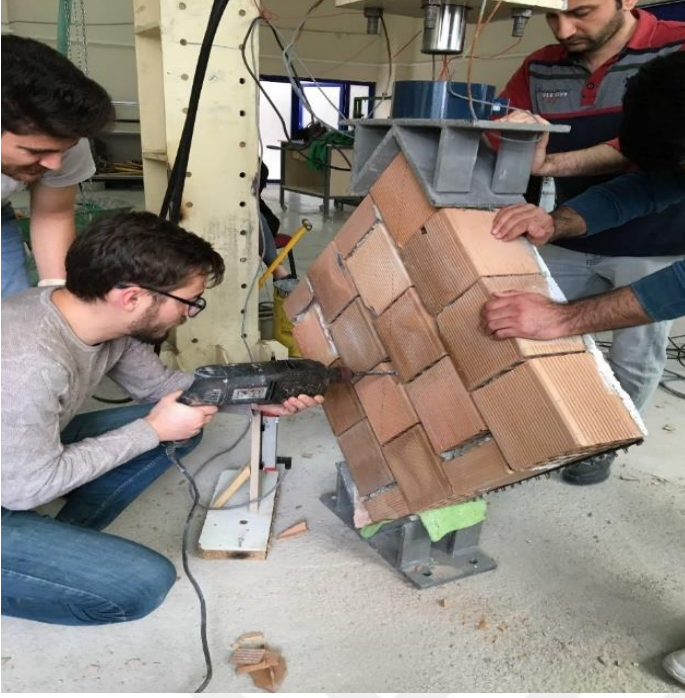
Resim 5.17. a) Tek yüzü Tür 2 ile güçlendirilmiş 1. tuğla duvar numunesinin diyagonal yükleme deneyine hazırlanması
