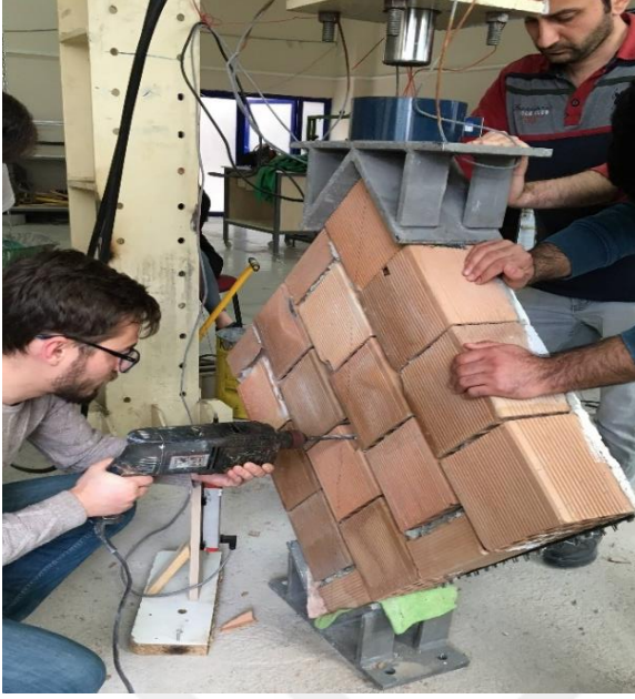
Resim 4.28. Tuğla duvarın matkapla delinmesi
