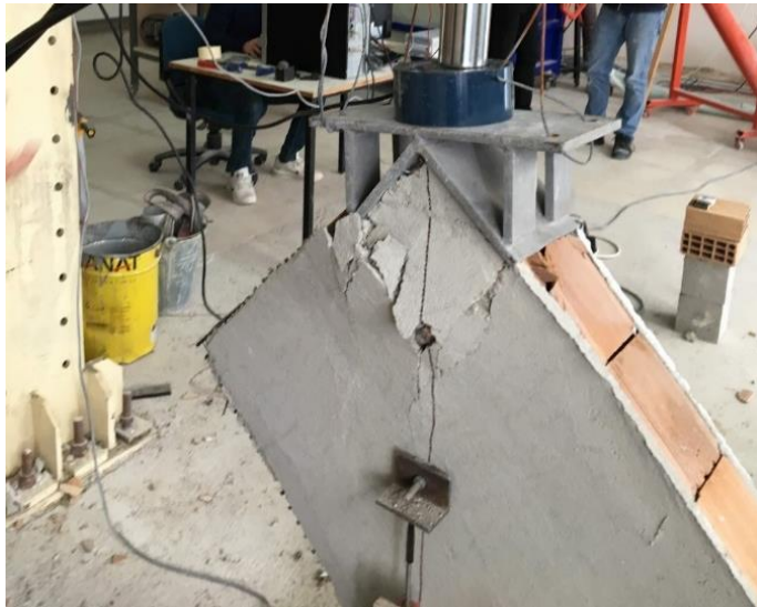
Resim 5.47. a) Diagonal yüklemeye sonrası çift yüzü Tür 2 ile güçlendirilmiş 1. tuğla duvar numunesinin arka yüzü
