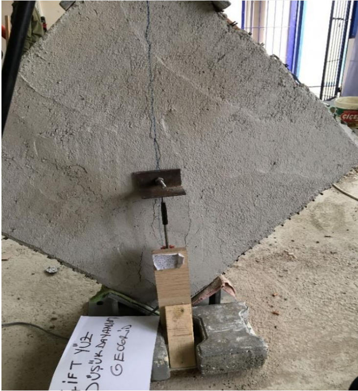
Resim 5.34. Diyagonal yükleme deneyi sonrası çift yüzü Tür 1 ile güçlendirilmiş 1. Numunenin arka yüzünde oluşan kılcal çatlaklar
