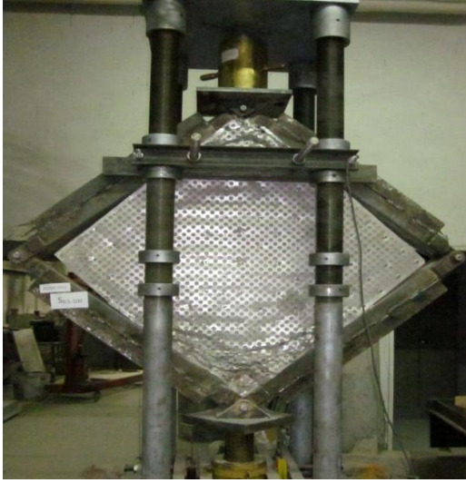
Resim 3.15. Delikli çelik levha ile güçlendirilmiş numunenin yükleme sonrası durumu (Seydanlıođlu, 2013)
