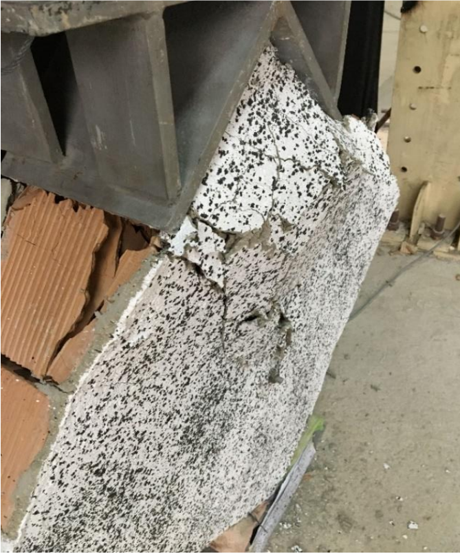
Resim 5.40. b) Diagonal yüklemeye sonrası çift yüzü Tür 1 ile güçlendirilmiş 2. tuğla duvar numunesinin ön yüzü
