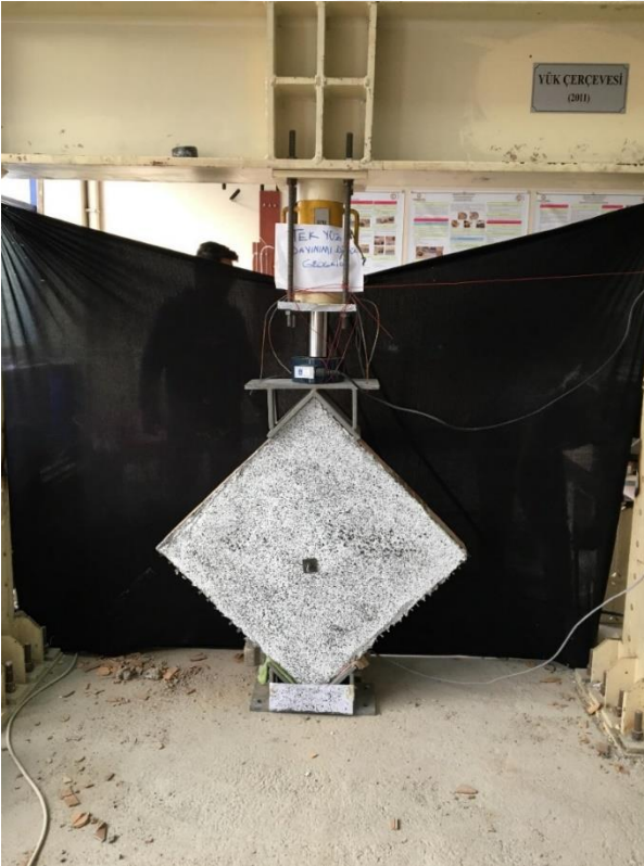
Resim 5.13. Diyagonal yükleme deneyine hazır tek yüzü Tür 1 ile güçlendirilmiş 2. tuğla duvar numunesinin ön yüzü
