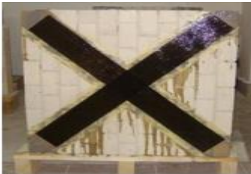
Resim 3.5. BFRP malzemenin duvara birinci uygulanma yöntemi (Leone, Sciolti ve Aiello, 2012)
