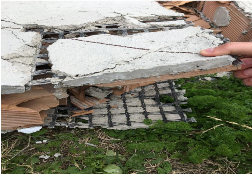
Resim 5.49. Diyagonal yükleme deneyi sonrası plastik kompozit donatının son durumu
