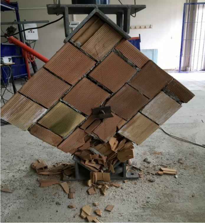
Resim 5.11. Diagonal yüklemeye deneye sonrasinda tek yüzü Tür 1 ile güçlendirilmiş 1. numunenin arka yüzünde oluşan hasarlar
