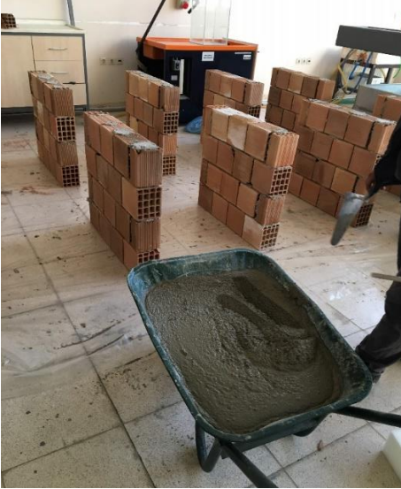
Resim 4.16. Numunelere uygulamak için hazırlanan sıva
