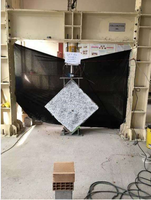
Resim 5.51. Diagonal yüklemeye hazır çift yüzü Tür 2 ile güçlendirilmiş 2. Tuğla numunesinin ön yüzü
