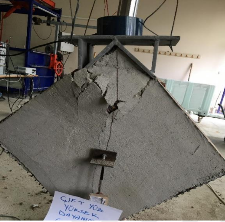
Resim 5.47. b) Diyagonal yükleme sonrası çift yüzü Tür 2 ile güçlendirilmiş 1. tuğla duvar numunesinin arka yüzü
