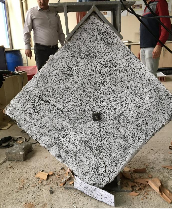
Resim 5.10. Diagonal yüklemeye deneye sonrasinda tek yüzü Tür 1 ile güçlendirilmiş 1. numunenin ön yüzü
