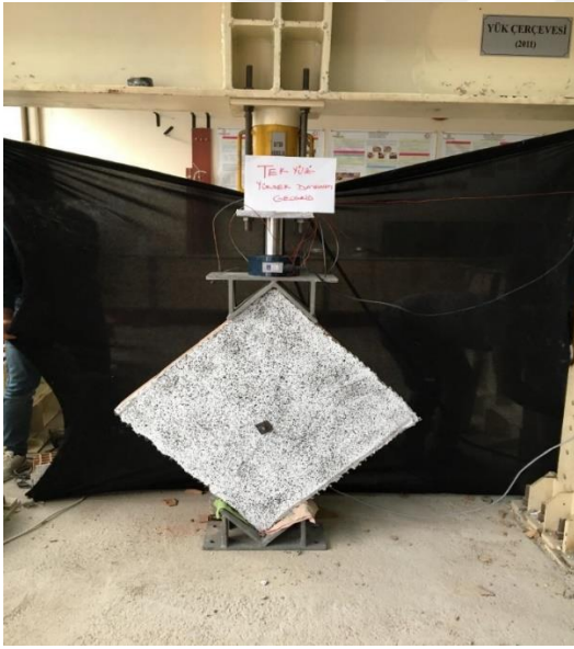
Resim 5.19. Diagonal yüklemeye hazır tek yüzü Tür 2 ile güçlendirilmiş 1. tuğla duvar numunesinin ön yüzü
