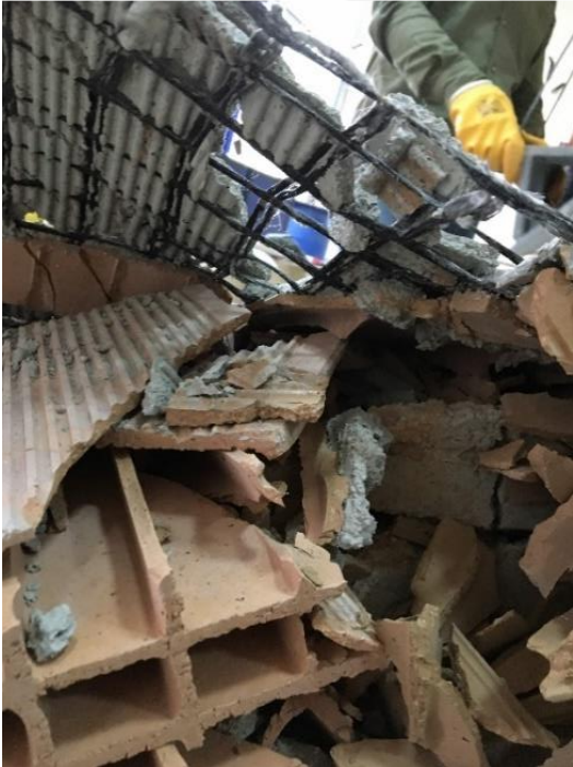
Resim 5.42. e) Diyagonal yükleme sonrası çift yüzü Tür 1 ile güçlendirilmiş 2. tuğla duvar numunesi
