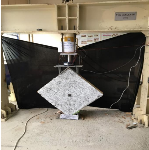
Resim 5.7. Diagonal yüklemeye hazır tek yüzü Tür 1 ile güçlendirilmiş 1. tuğla duvarın ön yüzü
