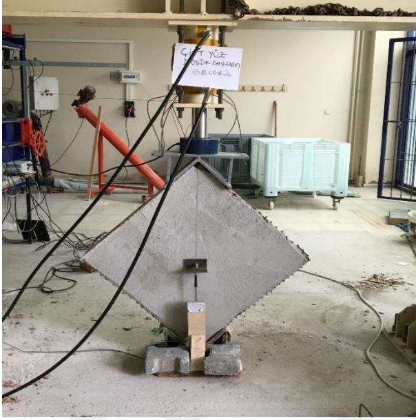
Resim 5.31. Diyagonal yükleme deneyine hazır çift yüzü Tür 1 ile güçlendirilmiş 1. tuğla duvar numunesinin arka yüzü
