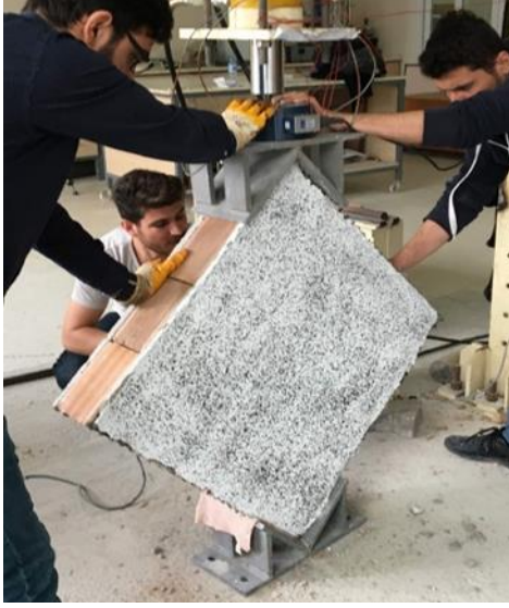
Resim 5.43. b) Çift yüzü Tür 2 ile güçlendirilmiş 1. tuğla duvar numunesinin diyagonal yükleme deneyine hazırlanması
