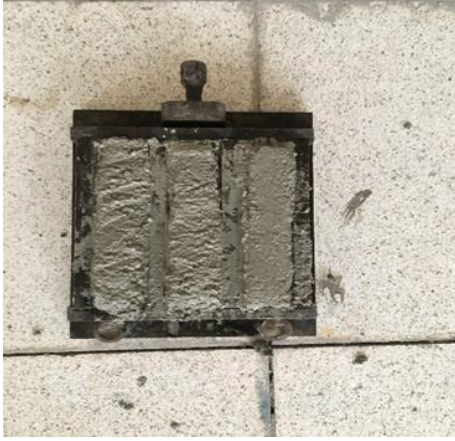
Resim 4.10. Kalıba yerleştirilmiş derz harcı
