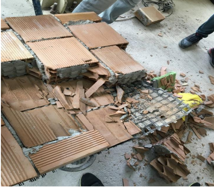
Resim 5.29. b) Diagonal yüklemeye deneyi sonrası tek yüzü Tür 2 ile güçlendirilmiş 2. tuğla duvar numunesi
