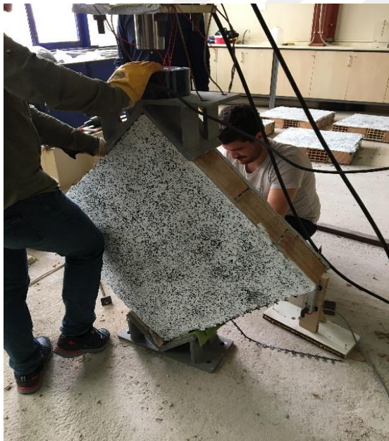
Resim 5.30. Çift yüzü Tör 1 ile güçlendirilmiş 1. tuğla duvar numunesinin diyagonal yükleme deneyine hazırlanması
