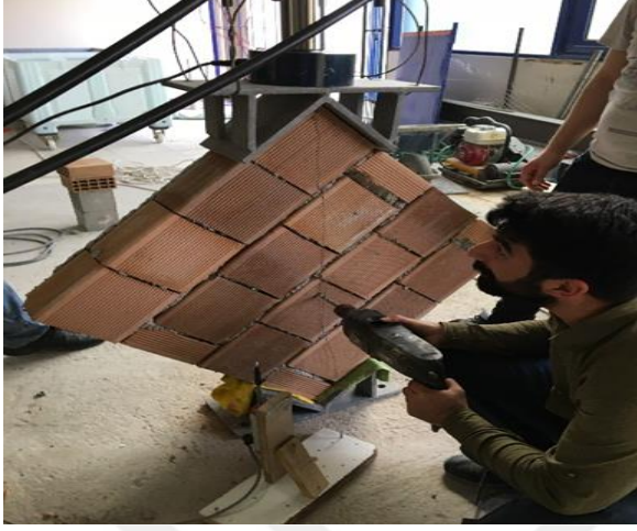
Resim 5.23. Tek yüzü Tür 2 ile güçlendirilmiş 2. tuğla duvar numunesinin diyagonal yüklemeye hazırlanması
