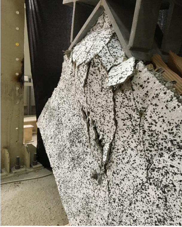
Resim 5.40. c) Diagonal yüklemeye sonrası çift yüzü Tür 1 ile güçlendirilmiş 2. tuğla duvar numunesinin ön yüzü
