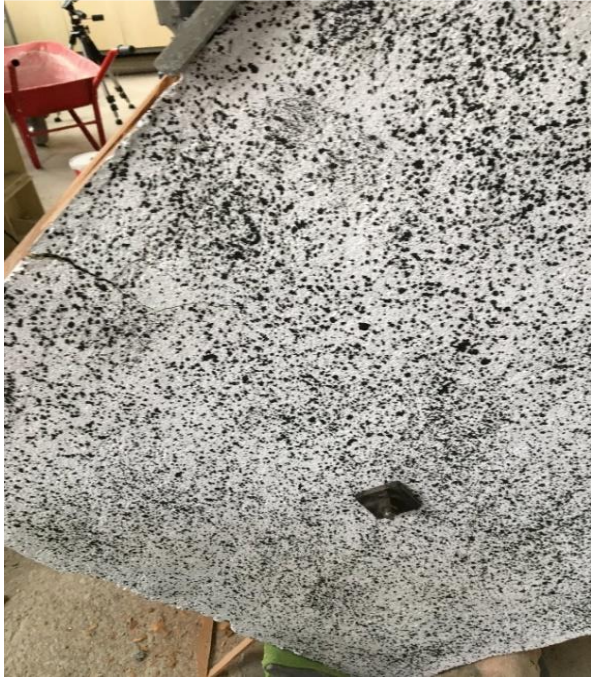
Resim 5.21. Diyagonal yükleme deneyi sonrasında tek yüzü Tür 2 ile güçlendirilmiş 1. tuğla duvar numunesinin ön yüzünde oluşan kılcal çatlaklar
