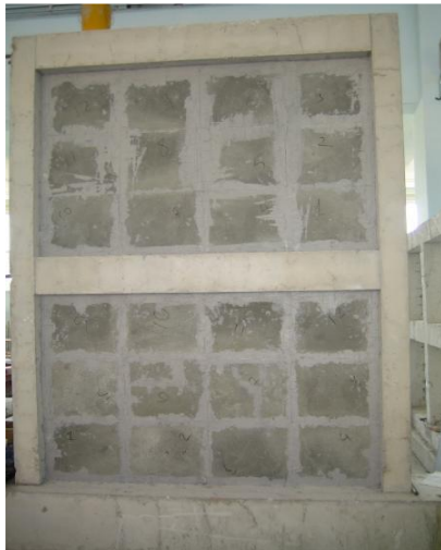
Resim 3.17. Güçlendirilen A tipi numune, (Sezer ve Akın. 2011)
