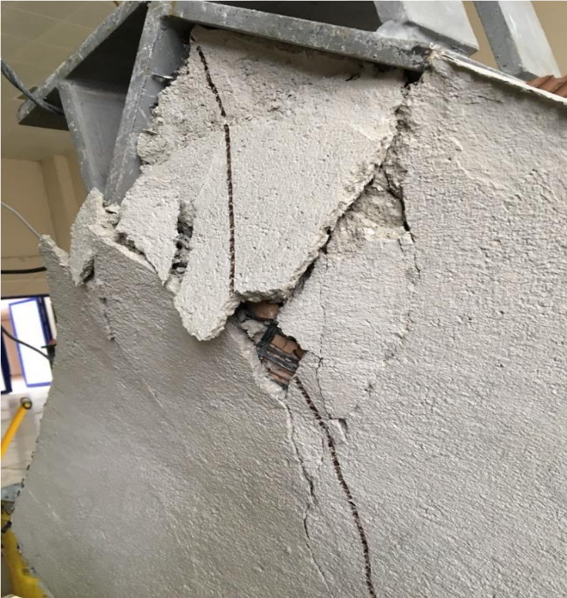
Resim 5.47. c) Diyagonal yükleme sonrası çift yüzü Tür 2 ile güçlendirilmiş 1. tuğla duvar numunesinin arka yüzü
