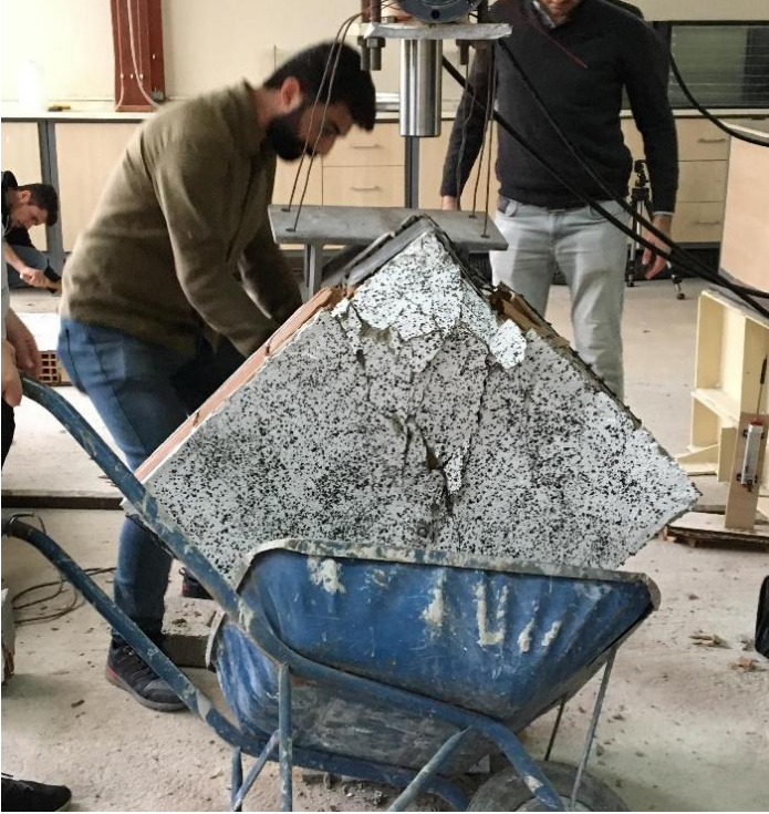
Resim 5.42. a) Diyagonal yükleme sonrası çift yüzü Tür 1 ile güçlendirilmiş 2. tuğla duvar numunesi
