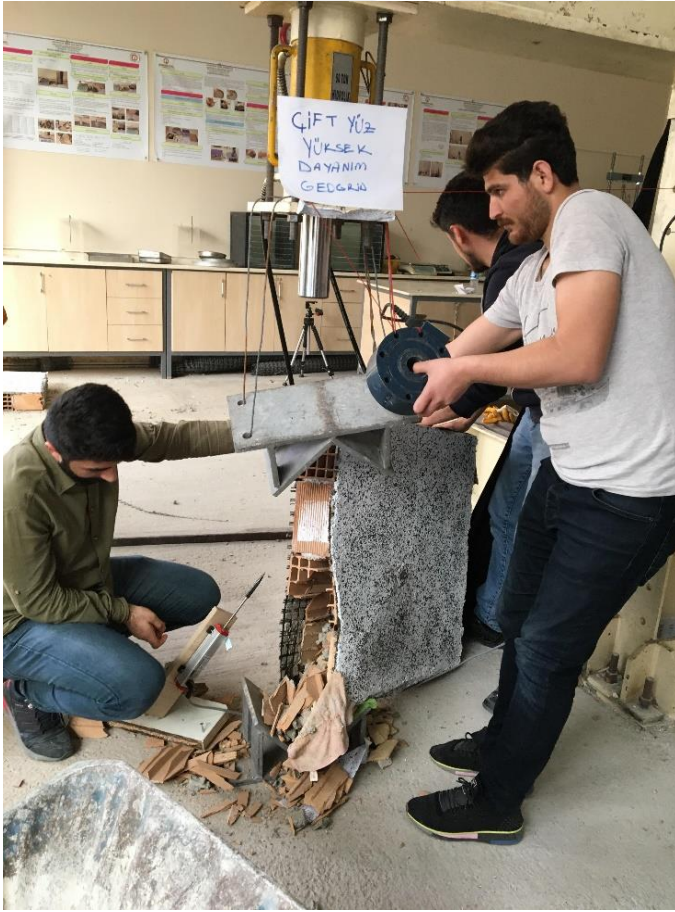
Resim 5.52. b) Diyagonal yükleme deneyi sonrası çift yüzü Tür 2 ile güçlendirilmiş 2. tuğla duvar numunesi
