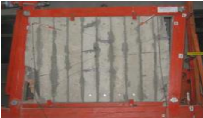
Resim 3.16. Betonarme panel uygulanmış tuğla duvar numunesi (Baran, Aktaş ve Aykaç, 2014)
