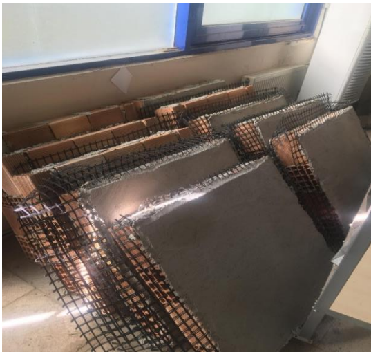
Resim 4.23. Sıva ve güçlendirme işlemlerinden sonra yükleme deneylerine hazır tuğla duvar numuneleri
