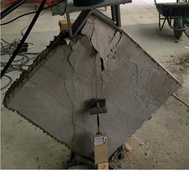
Resim 5.41. Diyagonal yükleme sonrası çift yüzü Tür 1 ile güçlendirilmiş 2. tuğla duvar numunesinin arka yüzü
