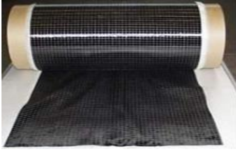
Resim 3.4. Deneyler için kullanılan CFRP malzeme (Coza, 2009)
