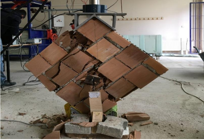
Resim 5.28. a) Diyagonal yükleme deneyi sonrası tek yüzü Tür 2 ile güçlendirilmiş 2. tuğla duvar numunesinin arka yüzünde oluşan hasarlar
