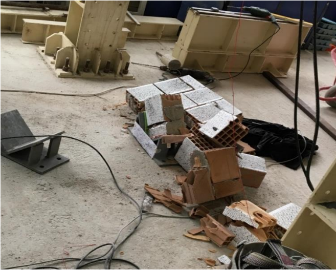
Resim 5.4. Diyagonal yükleme deneyi sonrası parçalanmış şahit numune
