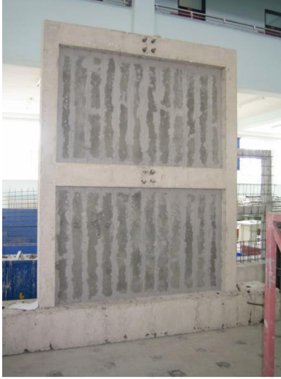
Resim 3.18. Güçlendirilen B tipi numune, (Sezer ve Akın. 2011)
