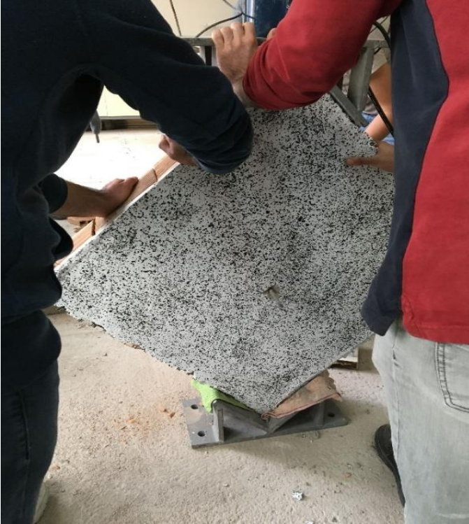
Resim 5.17. b) Tek yüzü Tür 2 ile güçlendirilmiş 1. tuğla duvar numunesinin diyagonal yükleme deneyine hazırlanması
