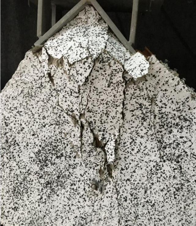
Resim 5.40. d) Diagonal yüklemeye sonrası çift yüzü Tür 1 ile güçlendirilmiş 2. tuğla duvar numunesinin ön yüzü
