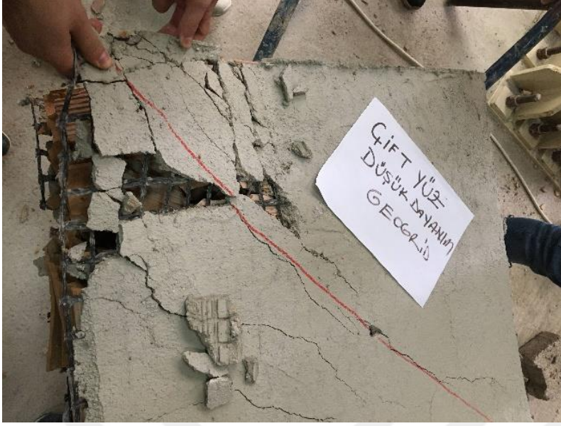
Resim 5.42. b) Diyagonal yüklemeye sonrası çift yüzü Tür 1 ile güçlendirilmiş 2. tuğla duvar numunesi
