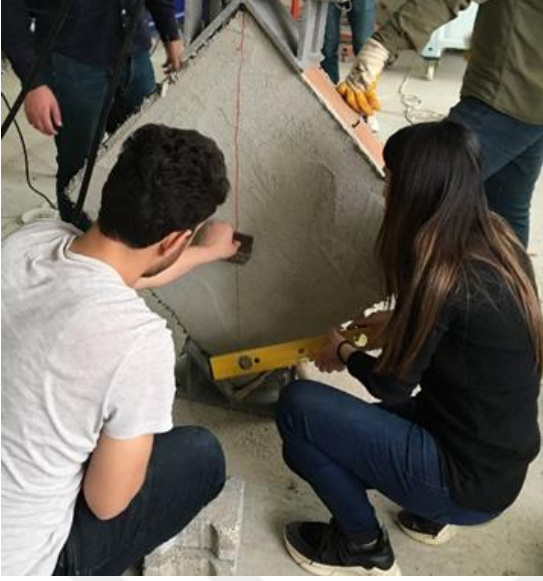
Resim 5.37. b) Çift yüzü Tür 1 ile güçlendirilmiş 2. Tuğla duvar numunesinin diyagonal yüklemeye hazırlanması
