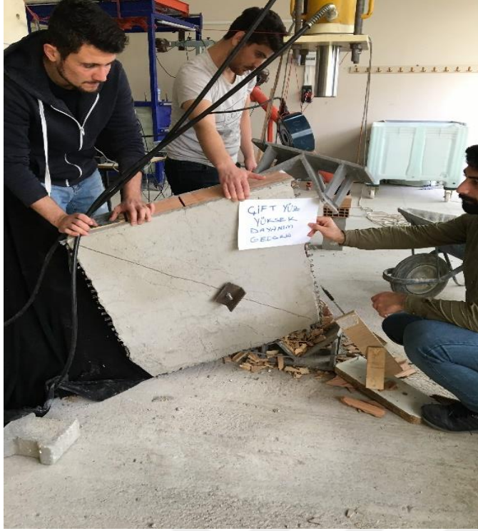
Resim 5.52. c) Diyagonal yükleme deneyi sonrası çift yüzü Tür 2 ile güçlendirilmiş 2. tuğla duvar numunesi
