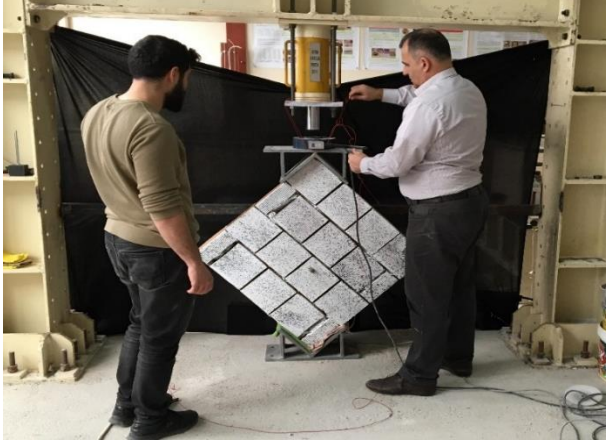
Resim 4.33. Yükleme başlığının sisteme yerleştirilmesi
