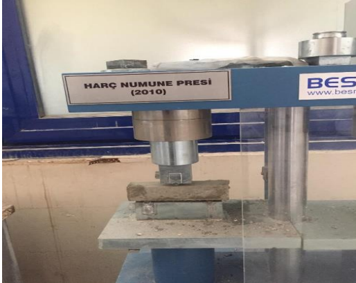
Resim 4.11. Eğilme dayanımının ölçülmesi için numunenin deney düzeneğine yerleştirilmesi
