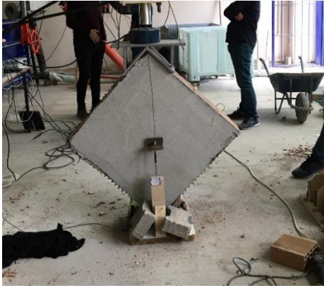
Resim 5.44. Diyagonal yükleme deneyine hazır çift yüzü Tür 2 ile güçlendirilmiş 1. Tuğla duvar numunesinin arka yüzü
