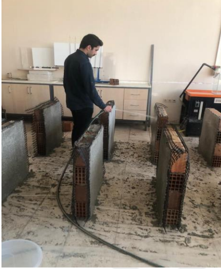
Resim 4.22. Sıva sonrası tuğla duvar numunelerinin sulanması
