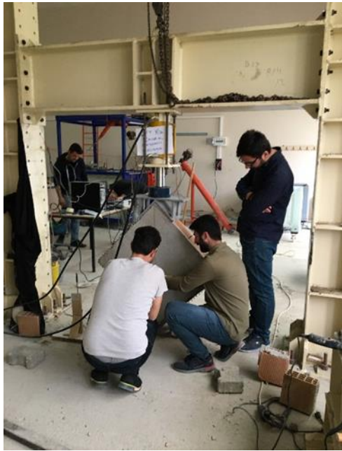
Resim 5.50. b) Çift yüzü Tür 2 ile güçlendirilmiş 2. tuğla duvarın diyagonal yükleme deneyine hazırlanması
