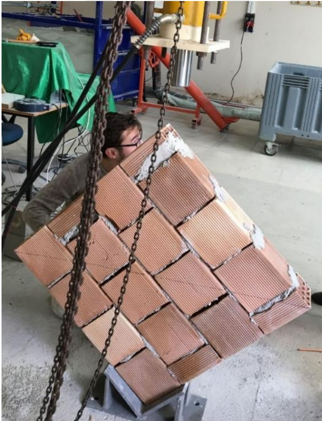
Resim 5.1. a) Şahit numunenin diyagonal yükleme deneyine hazırlanması
