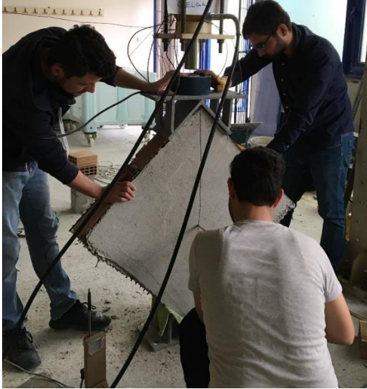
Resim 5.43. a) Çift yüzü Tür 2 ile güçlendirilmiş 1. tuğla duvar numunesinin diyagonal yükleme deneyine hazırlanması
