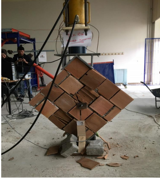
Resim 5.20. Diyagonal yükleme deneyi sonrasında tek yüzü Tür 2 ile güçlendirilmiş 1. tuğla duvar numunesinin arka yüzünde oluşan hasarlar
