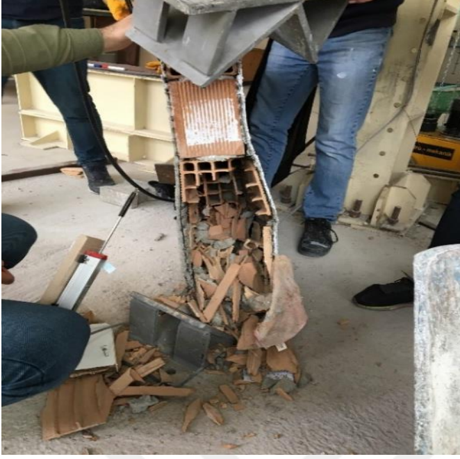
Resim 5.52. a) Diyagonal yükleme deneyi sonrası çift yüzü Tür 2 ile güçlendirilmiş 2. tuğla duvar numunesi
