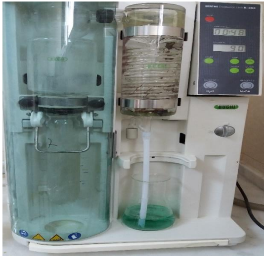
Resim 3.13. Makroalglerin Kjeldahl cihazı ile destilasyon işlemi
