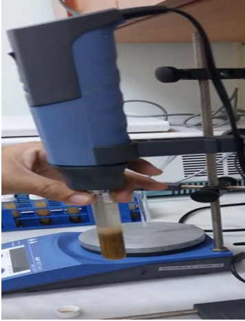
Resim 3.11. Makroalglerin yağ ekstraksiyonu işlemi sırasında homojenizasyonu
