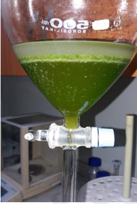
Resim 3.19. Ekstraksiyon karışımının ayırma hunusunda ayrılması
