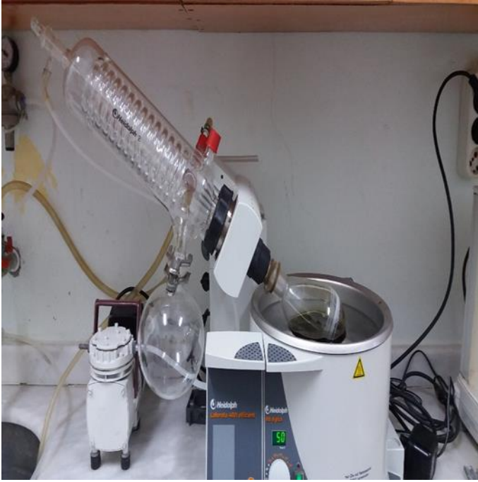
Resim 3.20. Evaporatör işlemiyle çözücülerin uçurulması
