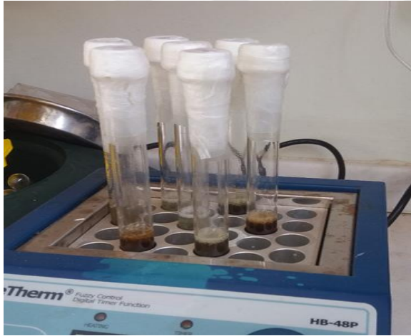
Resim 3.16. Makroalglerin lipit dokularının parçalanması için ısıtılması
