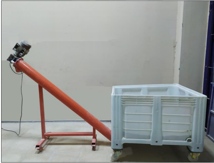
Resim 5.2. Zemin aktarma düzeneđi ve zemin depolama haznesi
