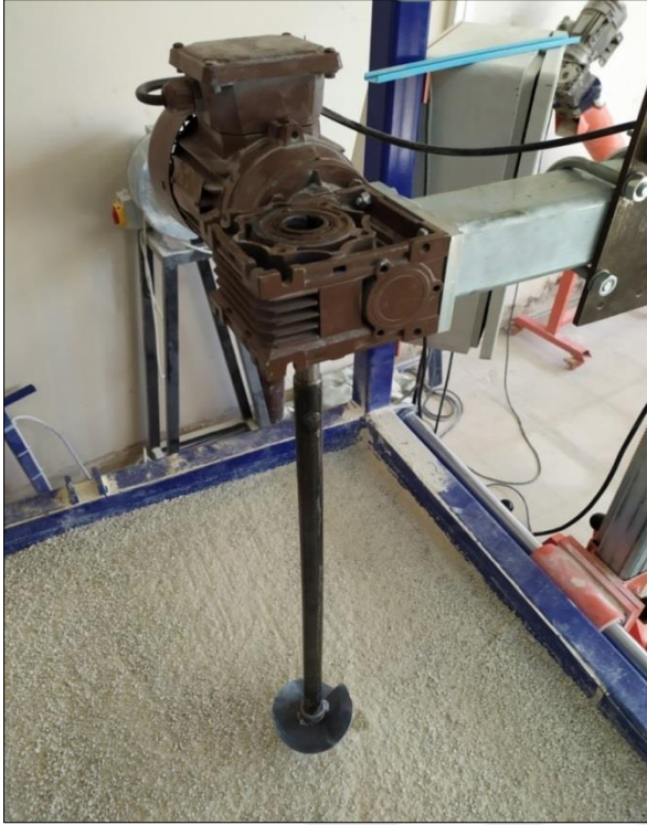
Resim 5.10. Helisel kazık montaj düzeneği
