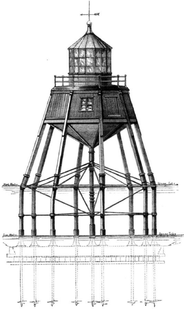
Şekil 3.6. Helisel kazıktan oluşan bir temel sistemiyle imal edilmiş deniz feneri (Sirsikar, 2018)
