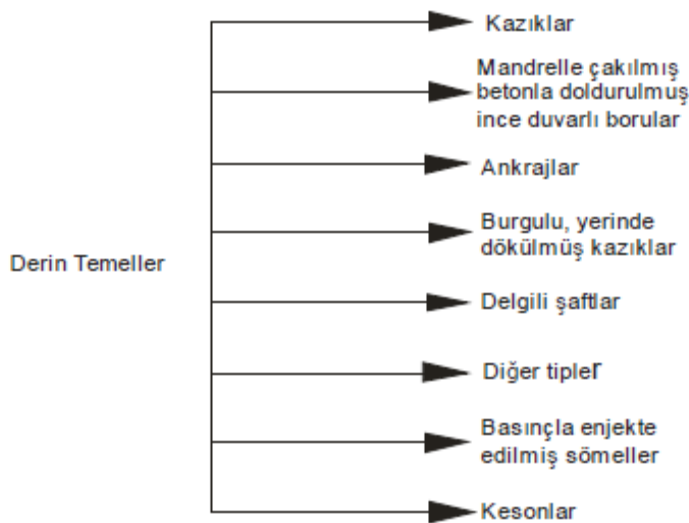
Şekil 3.2. Derin temel sistemlerinde kullanılan bazı temel çeşitleri (Coduto, 2001)
