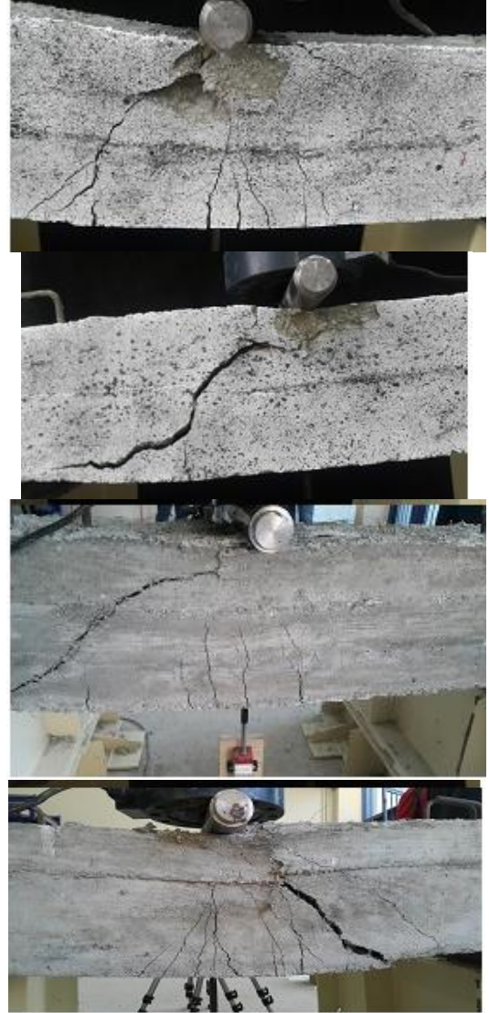
Şekil 15. Sırasıyla; Şahit1, Şahit2, 0.6MFSD1 ve 0.6MFSD2 kirişlerinin 3 noktalı yükleme deneyi sonrası durumları
