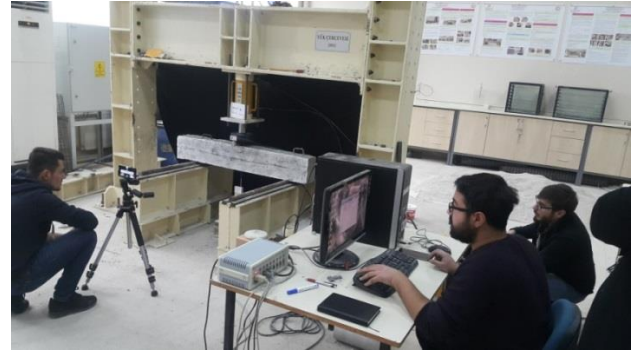
Şekil 9. 3 noktalı yükleme deneyi ve verilerin toplanması
