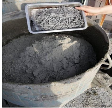
Şekil 3. Beton karışımına MFSD katılması
