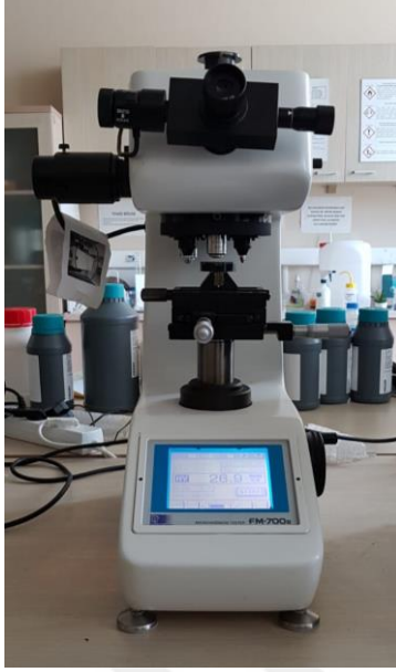
Resim 3.9. Future Tech 700e marka mikro sertlik test cihazı
