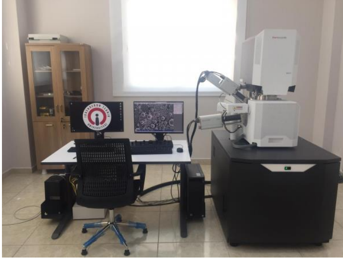
Resim 3.5. Thermo Scientific Apreo S SEM ve EDS cihazı
