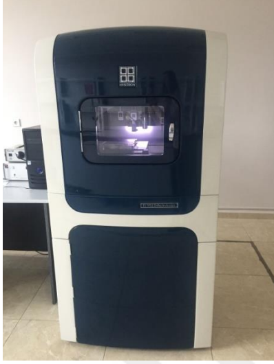
Resim 3.8. Hysitron TI-950 TriboIndenter nanoindentasyon cihazı
