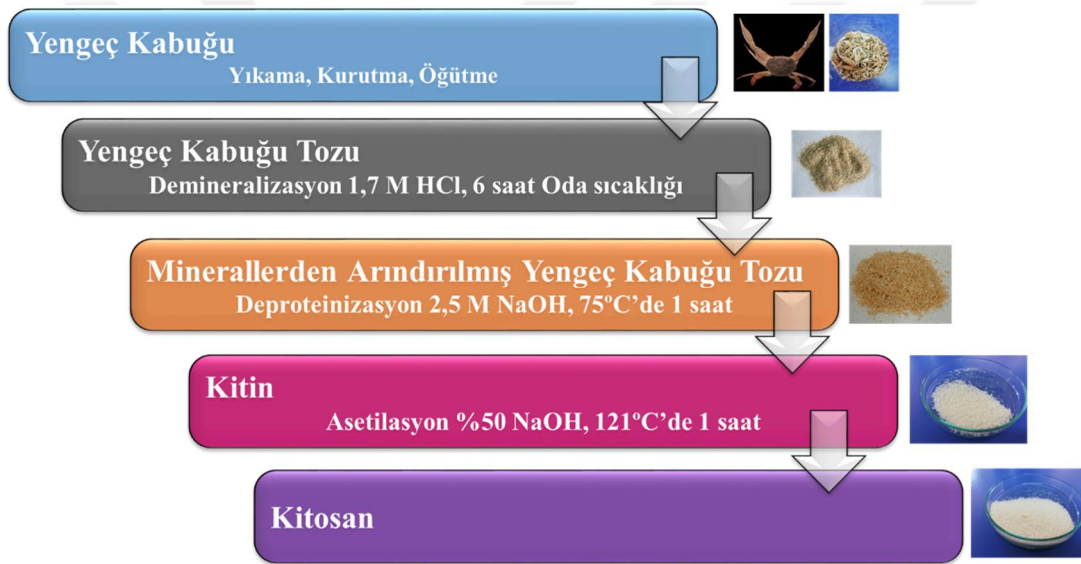
Şekil 3.4. Kitin ve Kitosan Ekstraksiyonunun Şematik Gösterimi
