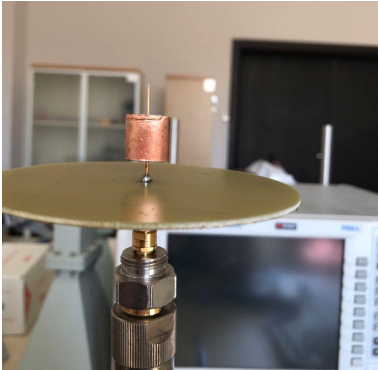
Resim 6.15. Boğucu halka (15mm) alt taştan 5mm yukarıda iken (2.28 GHz)
