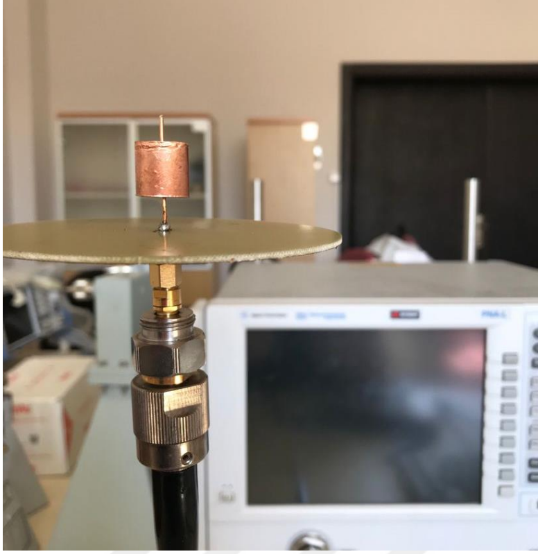
Resim 6.8. Boğucu halka (15mm) alt taştan 7.5mm yukarıda iken (1.8 GHz)
