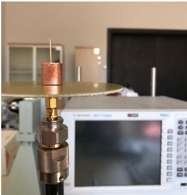
Resim 6.13. Boğucu halka (15mm) alt taşta temas halinde iken (2.28 GHz)
