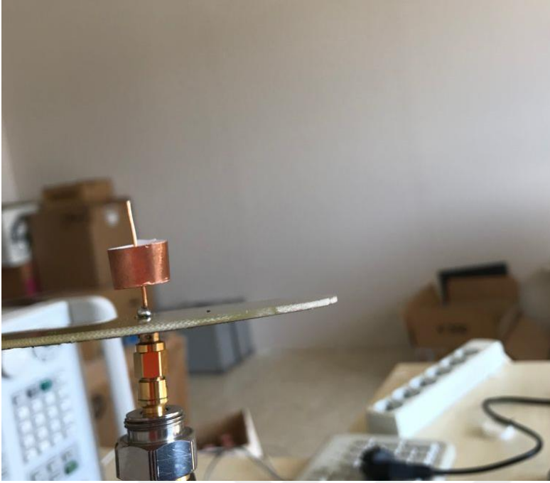
Resim 6.4. Boğucu halka (10mm) alt taştan 5mm yukarıda iken (1.8 GHz)
