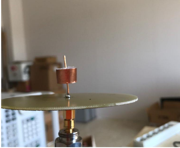
Resim 6.5. Boğucu halka (10mm) alt taştan 7.5mm yukarıda iken (1.8 GHz)
