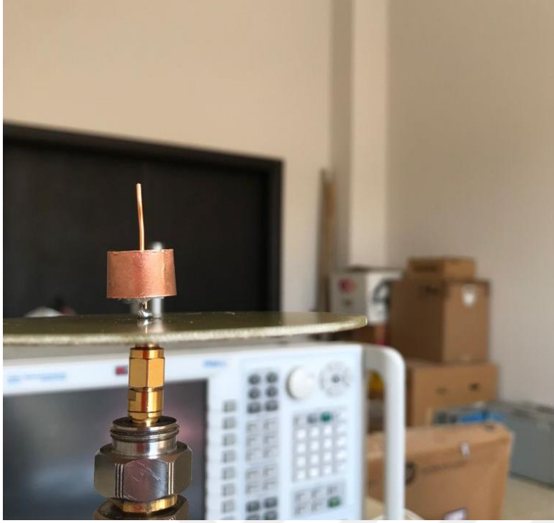
Resim 6.10. Boğucu halka (10mm) alt taştan 2.5mm yukarıda iken (2.28 GHz)
