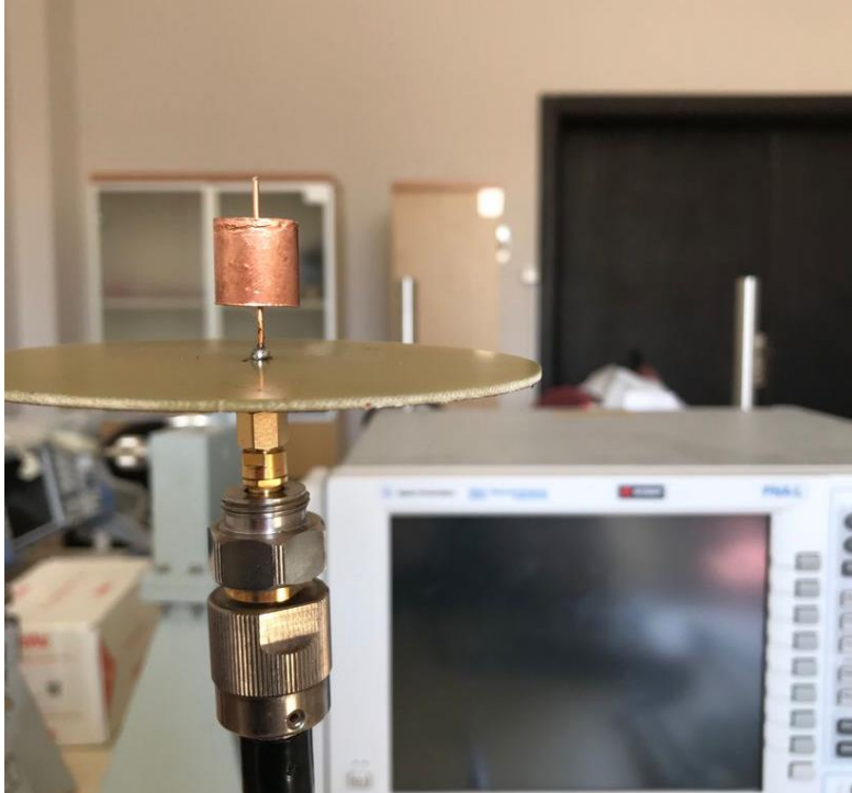
Resim 6.16. Boğucu halka (15mm) alt taştan 7.5mm yukarıda iken (2.28 GHz)
