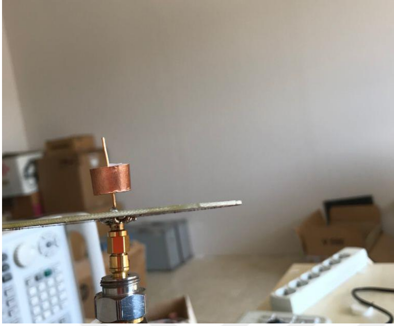
Resim 6.11. Boğucu halka (10mm) alt taştan 5mm yukarıda iken (2.28 GHz)
