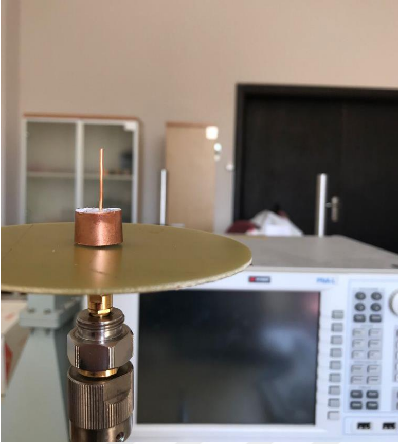
Resim 6.9. Boğucu halka (10mm) alt taşta temas halinde iken (2.28 GHz)
