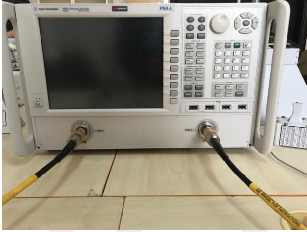
Resim 5.1. Ölçüm sırasında kullanılan vektör network analizör cihazı
