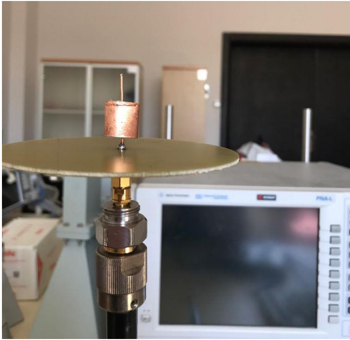
Resim 6.6. Boğucu halka (15mm) alt taştan 2.5mm yukarıda iken (1.8 GHz)
