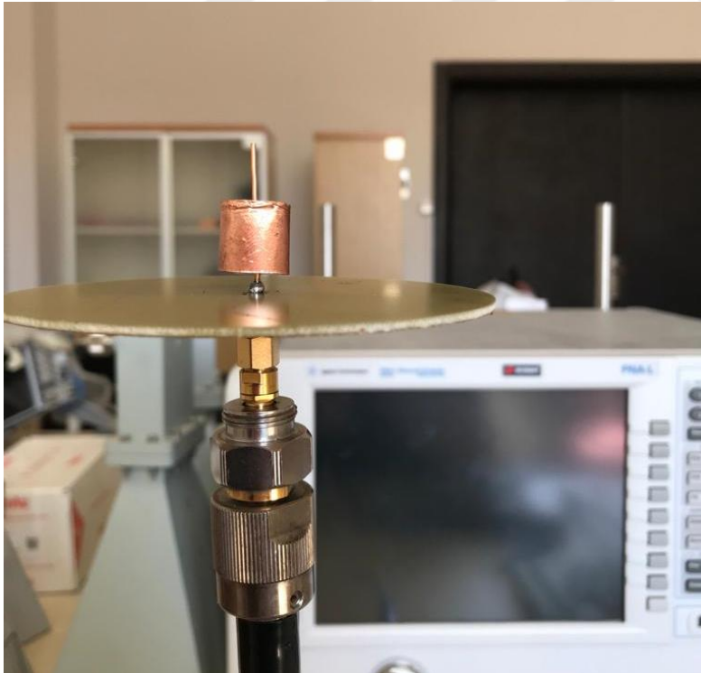
Resim 6.14. Boğucu halka (15mm) alt taştan 2.5mm yukarıda iken (2.28 GHz)
