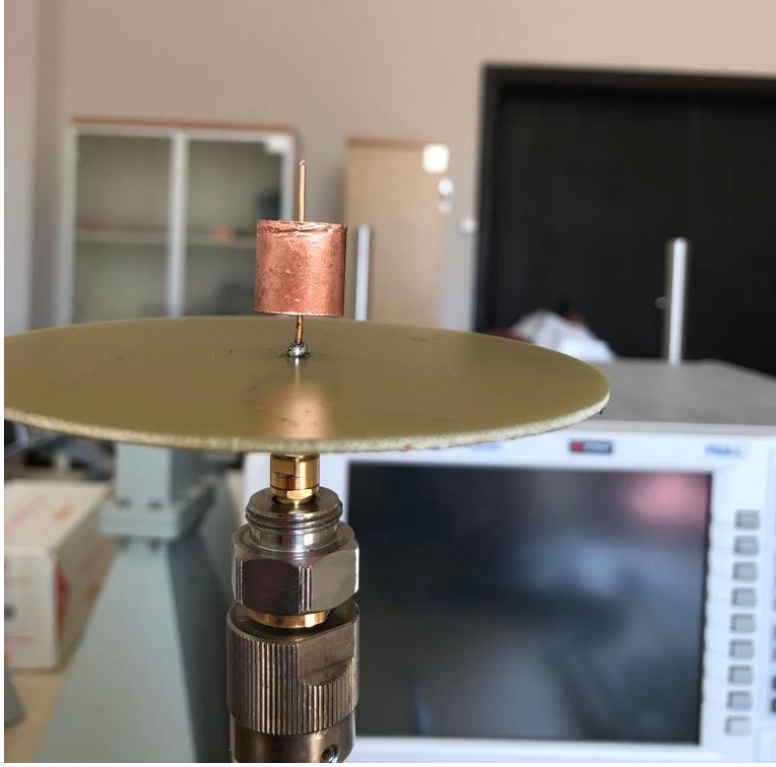
Resim 6.7. Boğucu halka (15mm) alt taştan 5mm yukarıda iken (1.8 GHz)
