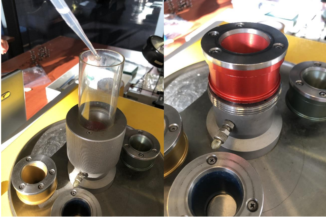
Resim 3.3. Membranın kabarcık noktasının, maksimum gözenek boyutunun ve hava geçirgenliğinin tespit edilmesi
