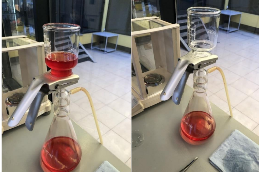
Resim 3.9. Tanklardan alınan numune sıvı ve incelticinin membran üzerinden akıtılması
