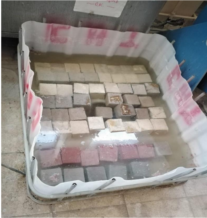
Resim 4.1. H_2SO_4 (sülfirik asit) çözeltisi içinde bekletilen numuneler
