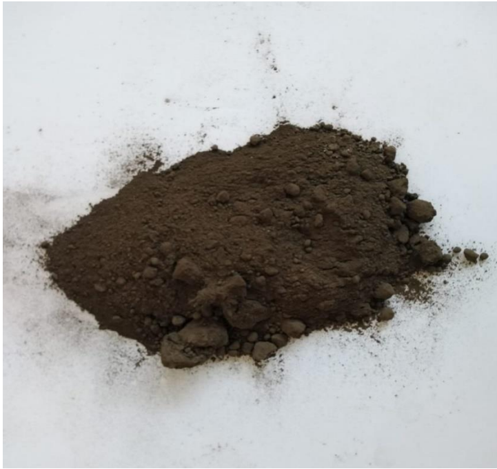
Resim 3.4.Beton üretiminde kullanılan Baca Tozu (BT)
