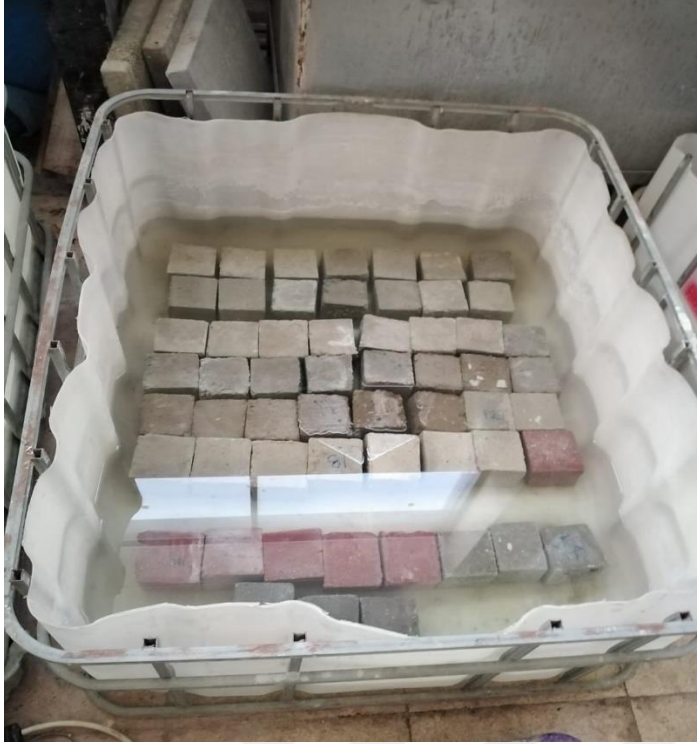
Resim 4.2. Na 2 SO 4 (sodyum sülfat) çözeltisi içinde bekletilen numuneler
