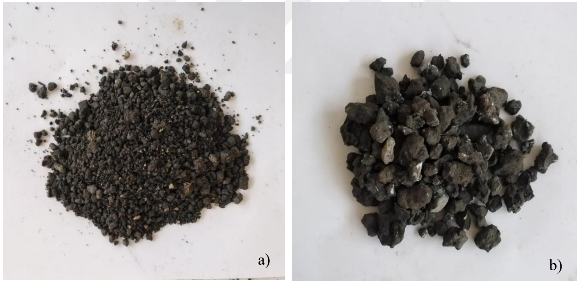
Resim 3.2.Beton üretiminde kullanılan EAFC a) 0-4 mm b) 4-11 mm
