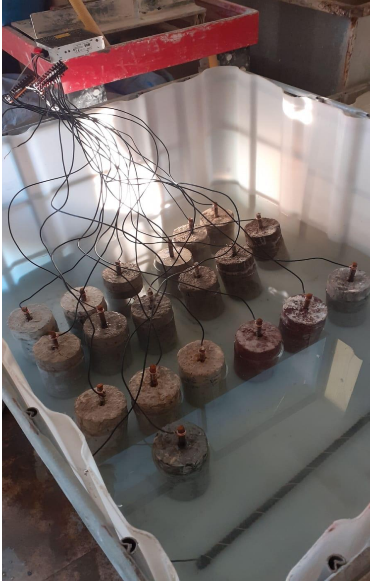
Resim 4.3. Hızlı korozyon testi düzeneği
