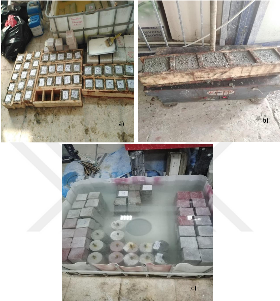
Resim 3.6. Beton üretim aşamaları a) betonun kalıplara yerleşmesi b) vibrasyon aşaması c) numunelerin kürlenmesi
