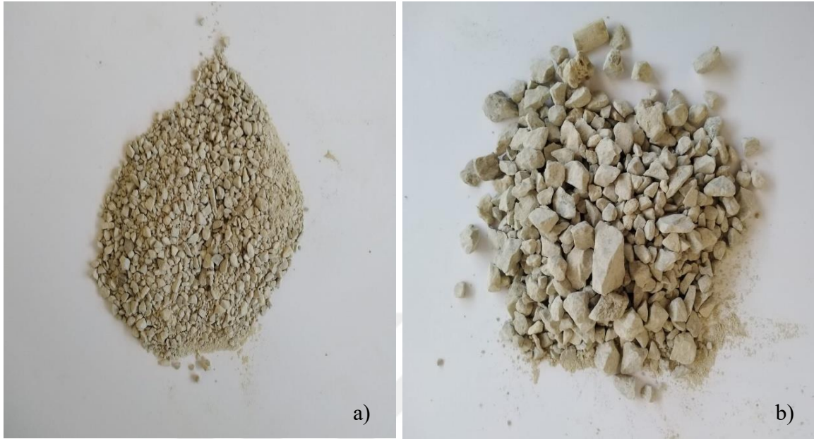
Resim 3.1. Beton üretiminde kullanılan doğal kırma taş agrega a) 0-4 mm b) 4-12 mm
