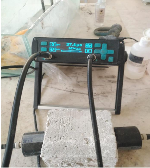
Resim 3.7.Ultrason ses geiş hızı deneyi
