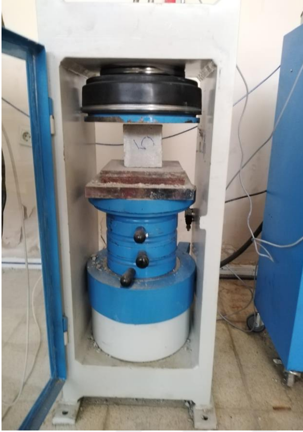
Resim 3.8. Beton basınç deneyi
