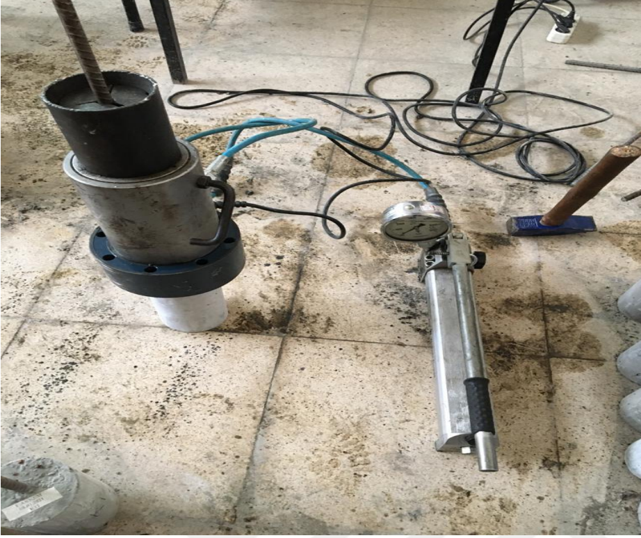
Şekil 3.18. Çekip çıkarma (pull out) deney düzeneği
