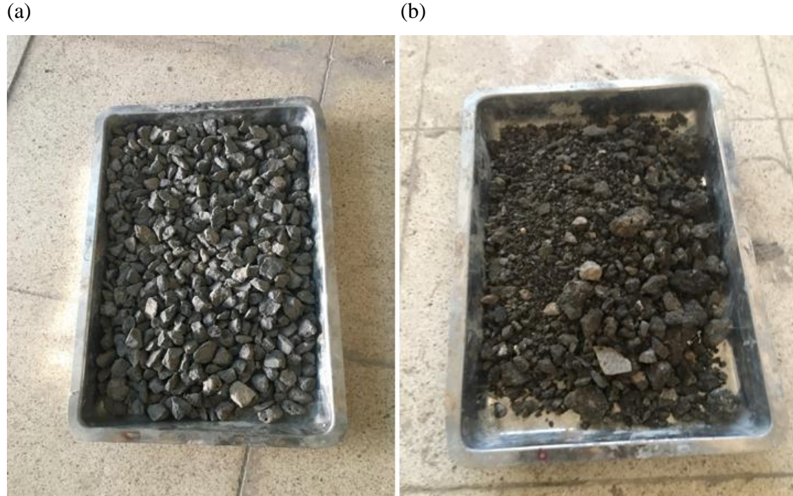
Şekil 3.1. Bazalt agregası (a) ve geri dönüştürülmüş bitümlü asfalt agregası (b)
