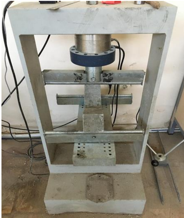
Şekil 3.5. 3 noktada eğilme deneyi düzeneği
