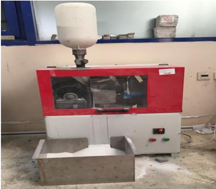
Şekil 3.7. Geniş diskli aşınma deney düzeneği
