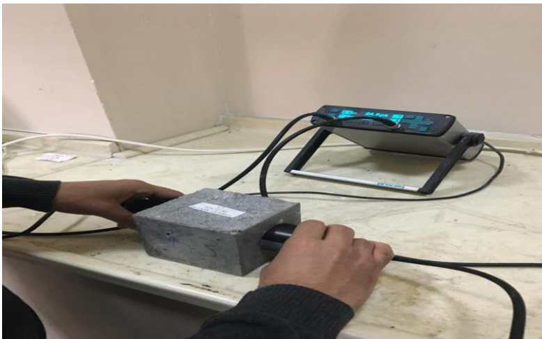
Şekil 3.9. Ultrasonik dalga hızı deney düzeneği
