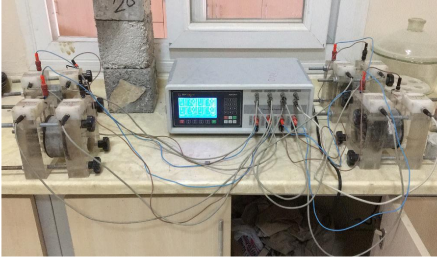
Şekil 3.15. Hızlı klor geçirimliliği deney düzeneği
