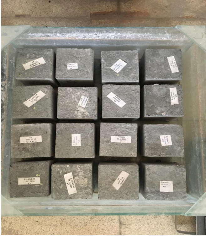
Şekil 3.13. Kapilarite deney düzeneği
