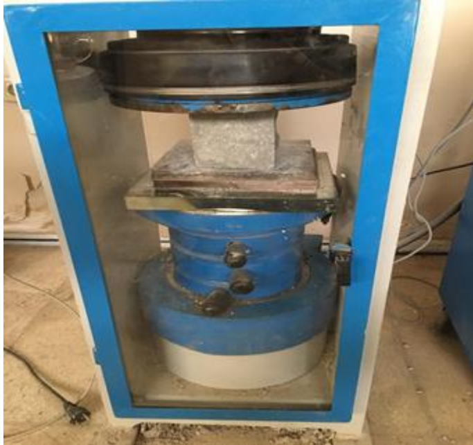
Şekil 3.4. Beton basınç dayanım deney düzeneği
