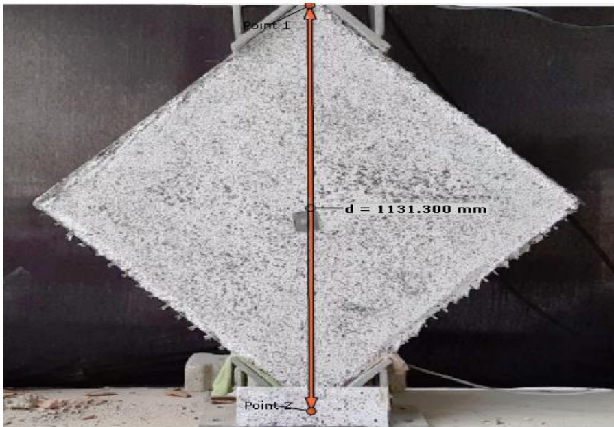
Şekil 4.17. Duvar numunelerinde DIC analizi için metrik kalibrasyonun yapılması
