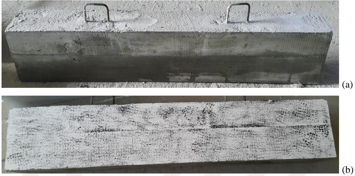
Şekil 4.1. Kiriş numuneleri DIC analizi için yüzey hazırlığı; (a) Doğal kiriş yüzeyi (b) Beneklenmiş kiriş yüzeyi
