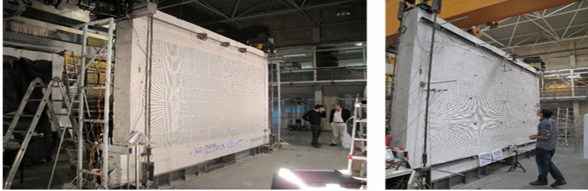
Şekil 2.3. Deneye tabi tutulan betonarme çerçeve içerisine yerleştirilmiş dolgu duvarları (Ramos ve arkadaşları, 2015)
