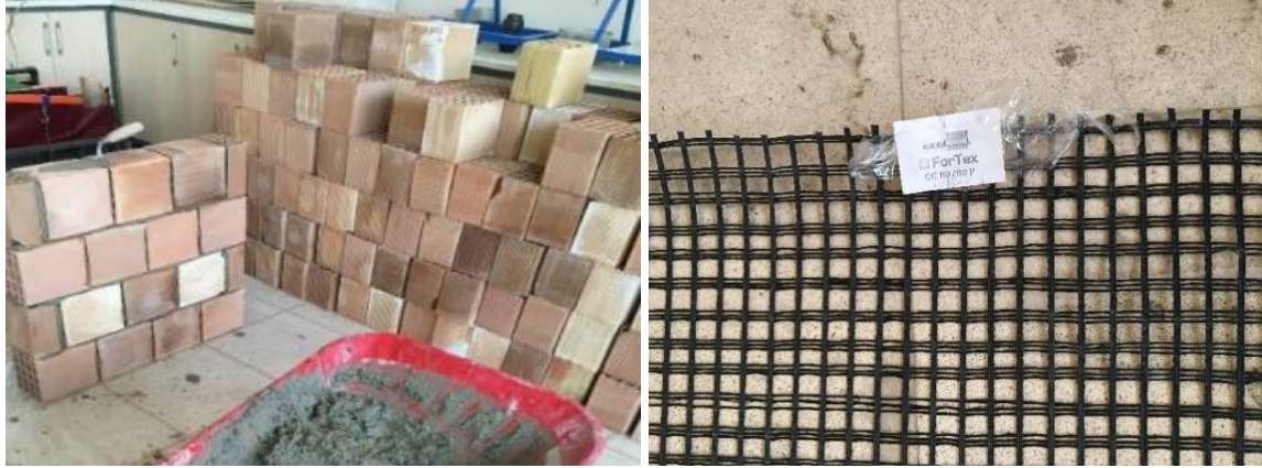
Şekil 4.14. Duvar imalatında kullanılan tuğla ve plastik kompozit donatı
