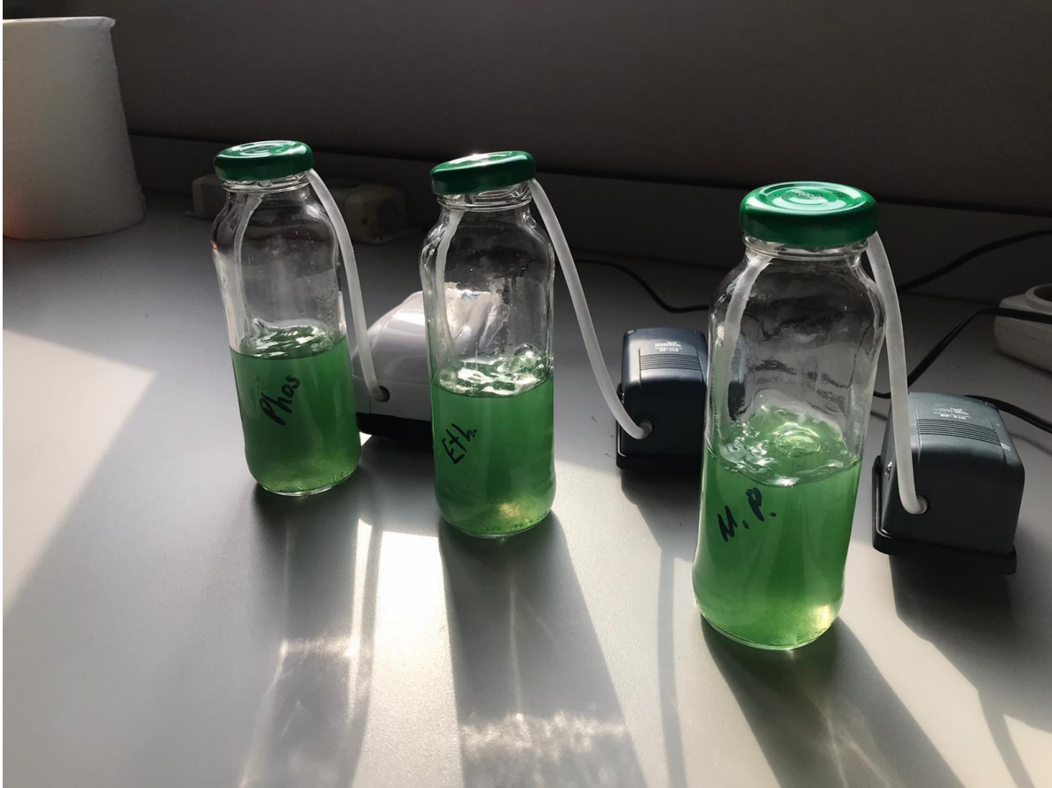
Resim 3.3. 250 mL lik şişelere hava veren kompresörler
