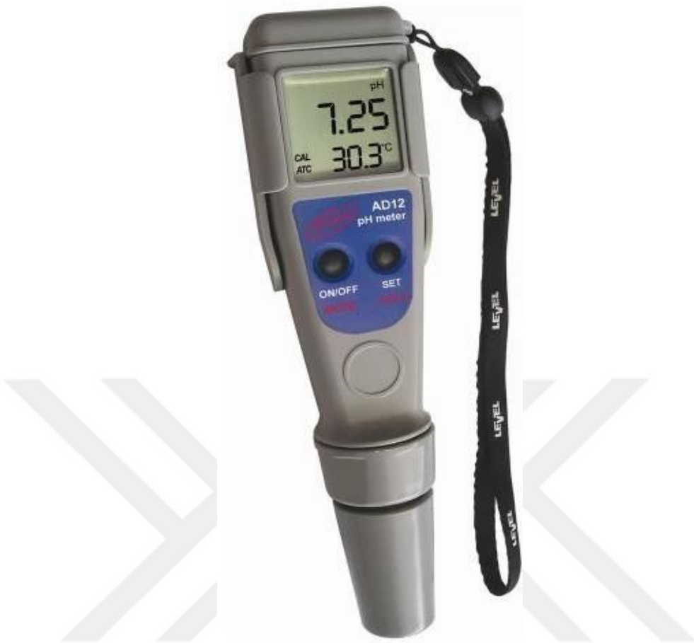
Resim 3.4. Spirulina platensis kültürlerinin ısı ve pH değerini ölçmede kullanılan cihaz
