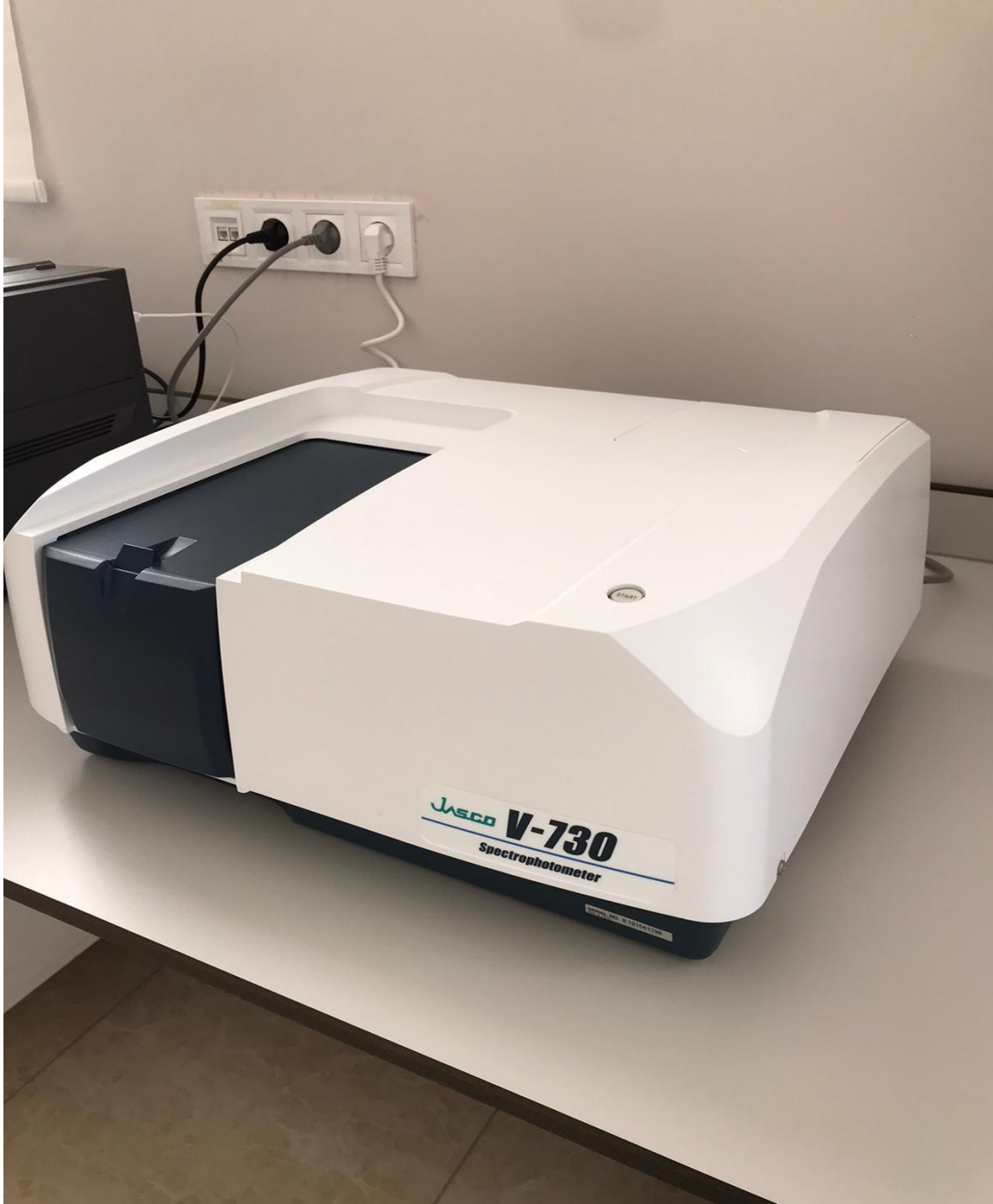
Resim 3.5. Spirulina platensis kültürlerinin optik yoğunluk değerini ölçmede kullanılan UV-Vis spektrofotometre cihazı
