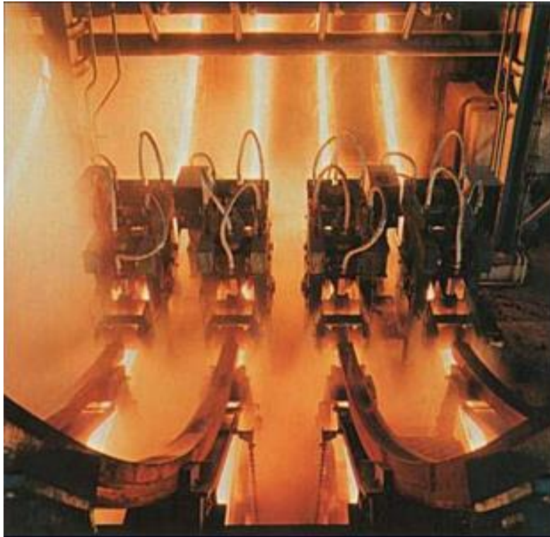
Resim 2.1. Çelik üretim aşaması-sıvı çeliğin soğutulup kütük demir elde edilmesi
