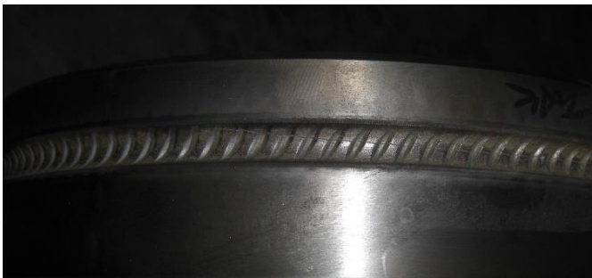
Resim 1.1. Nervür izi veren çelik ringin aşınması
