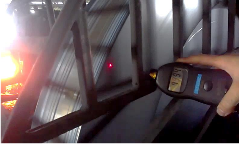
Resim 3.14. Volan açısal hızının ölçülmesi
