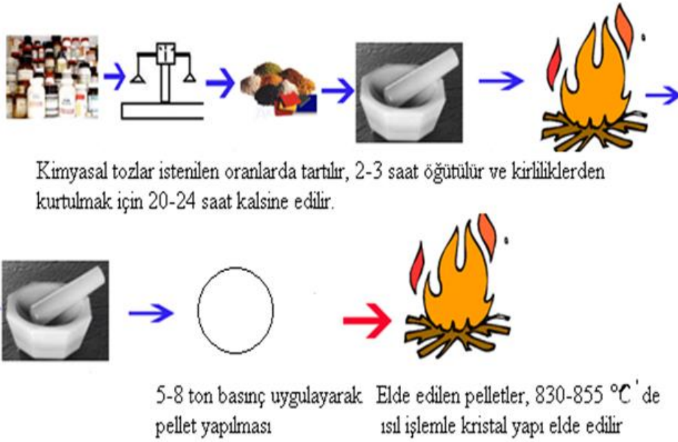
Şekil.2.1. Katı-hal tekniğiyle üretim adımlarının şematik gösterimi
