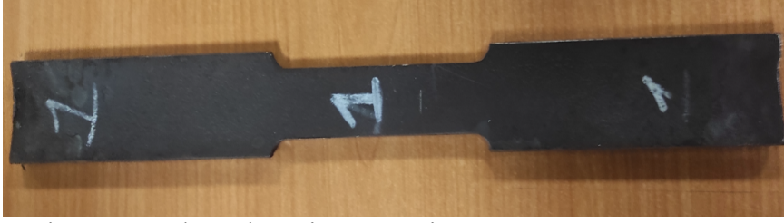
Resim 3.13. Çekme deneyi numunesi
