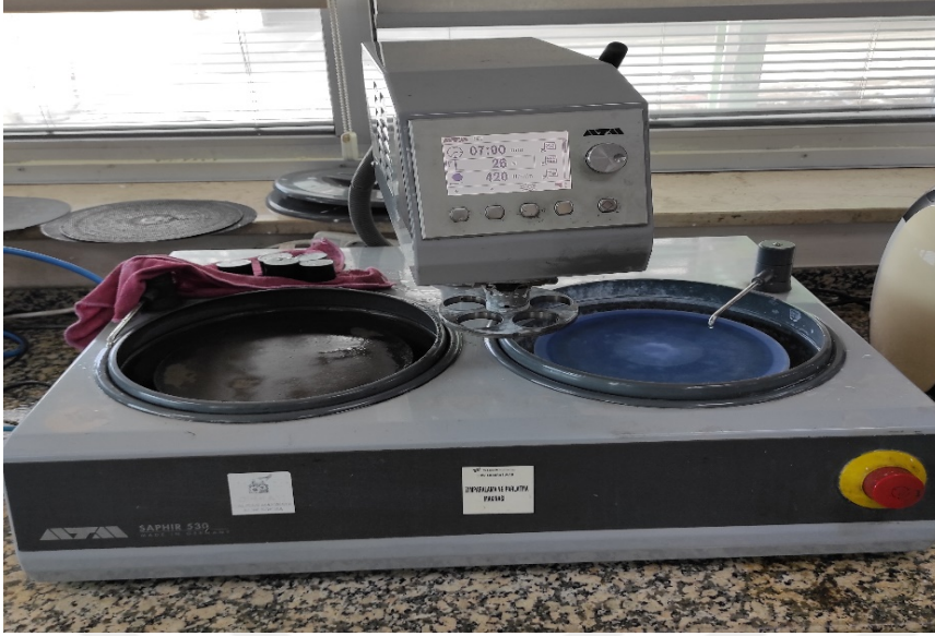
Resim 3. 7. Ata Saphir 530 zımparalama ve parlatma cihazı
