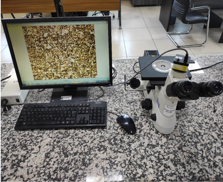
Resim 3.10. Nikon Eclipse MA 100 optik mikroskobu
