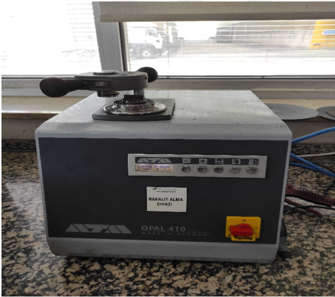
Resim 3.6. Ata Opal 410 bakalit alma cihazı
