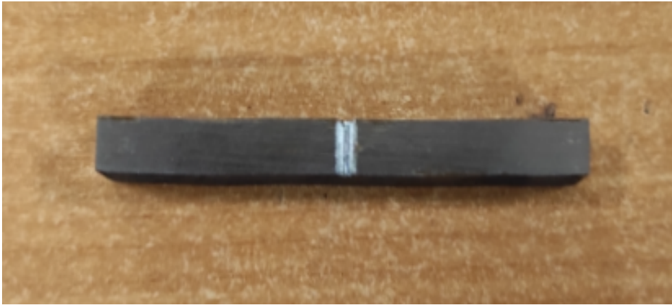
Resim 3.15. Çentik darbe deneyi numunesi
