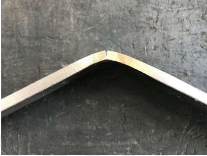
Şekil 4.16. Yüksek ısı girdili bağlantıdan çıkarılan kök bükme numunesindeki çatlayan bölgeyi gösteren makro resim. (Çatlak iri taneli IEB’de meydana gelmiştir.)
