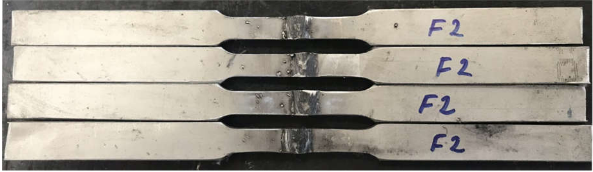
Şekil 3.7. Yüksek ısı girdili kaynaklı bağlantıdan çıkarılan çekme numunelerinin test öncesi görünümü
