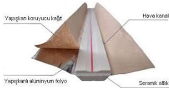
Şekil 3.2. Kaynak denemelerinde kullanılan seramik altlık
