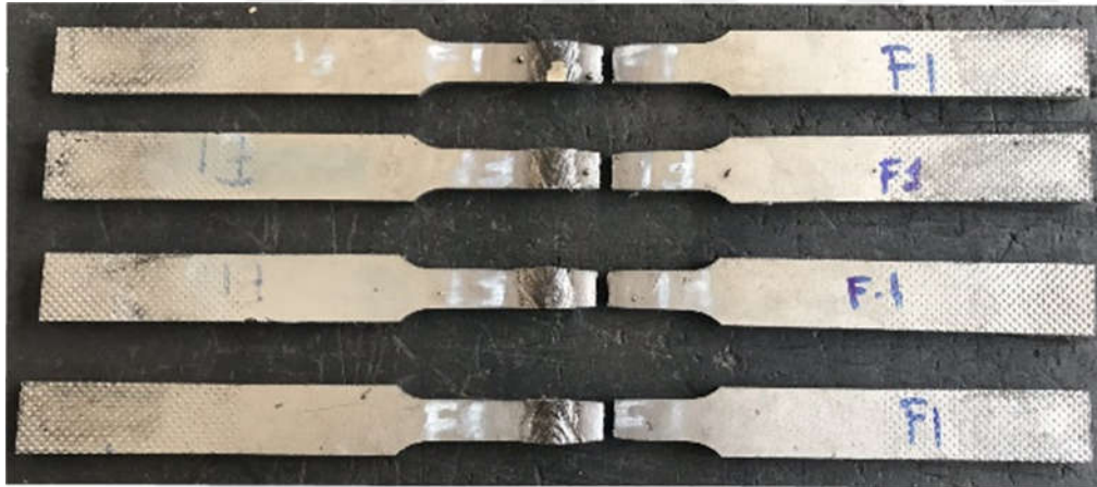
Şekil 4.10. Düşük ısı girdili kaynaklı bağlantıdan çıkarılan çekme numunelerinin deney sonrası kırılmanın baz plaka içerisinde gerçekleştiğini gösteren makro resimler
