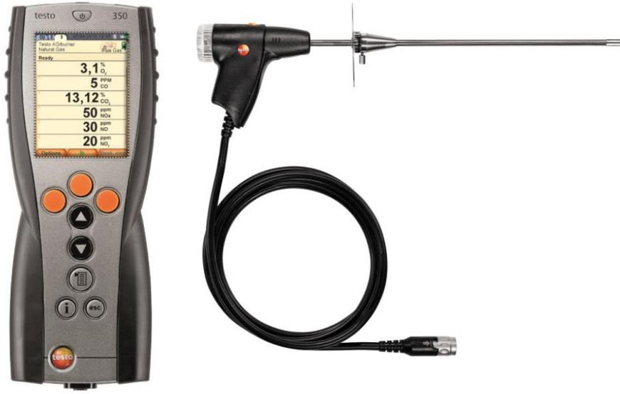
Şekil 3.9. Testo 350 Gaz analizörü ve probu
