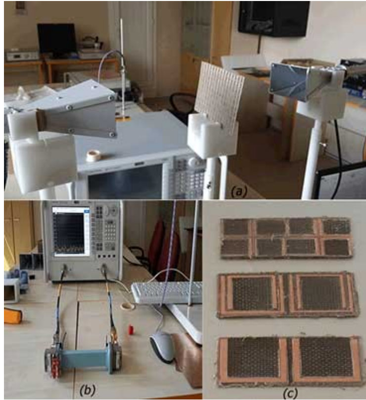
Şekil 4.1. Deneysel çalışma ortamı (a) periyodik üretilmiş bir U şekilli yapı (b) dalga kılavuzu ölçüm ortamı (c) dalga kılavuzu ölçümleri için üretilmiş U şekilli yapılar
