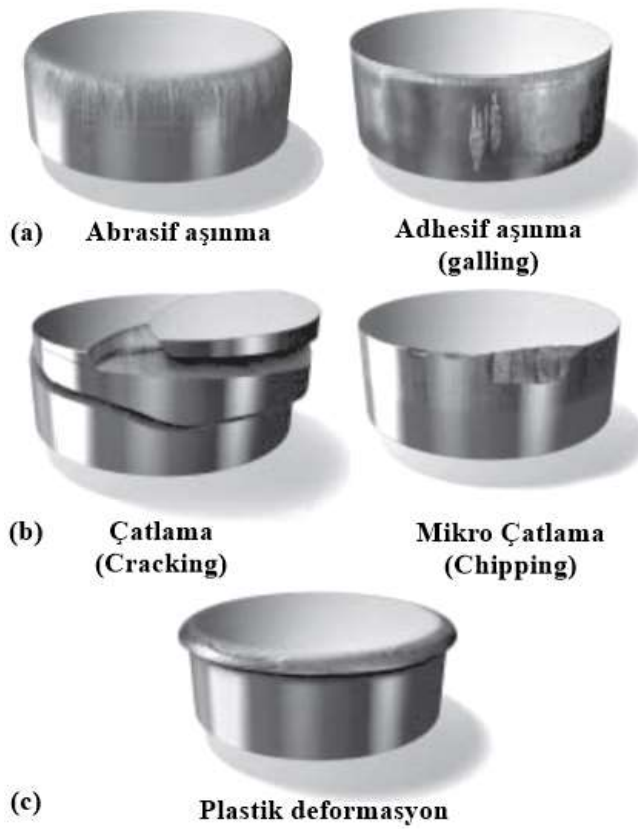
Şekil 4.1. (a) malzeme kaybına sebep olan abrazif-adhezif aşınma, (b) keskin uçlarda, çatlamalara ve mikro çatlamların yayılarak oluşturduğu hasarlar, (c) şekillendirme işlemi sırasında yüksek gerilimler sonucu meydana gelen plastik deformasyon [31].
