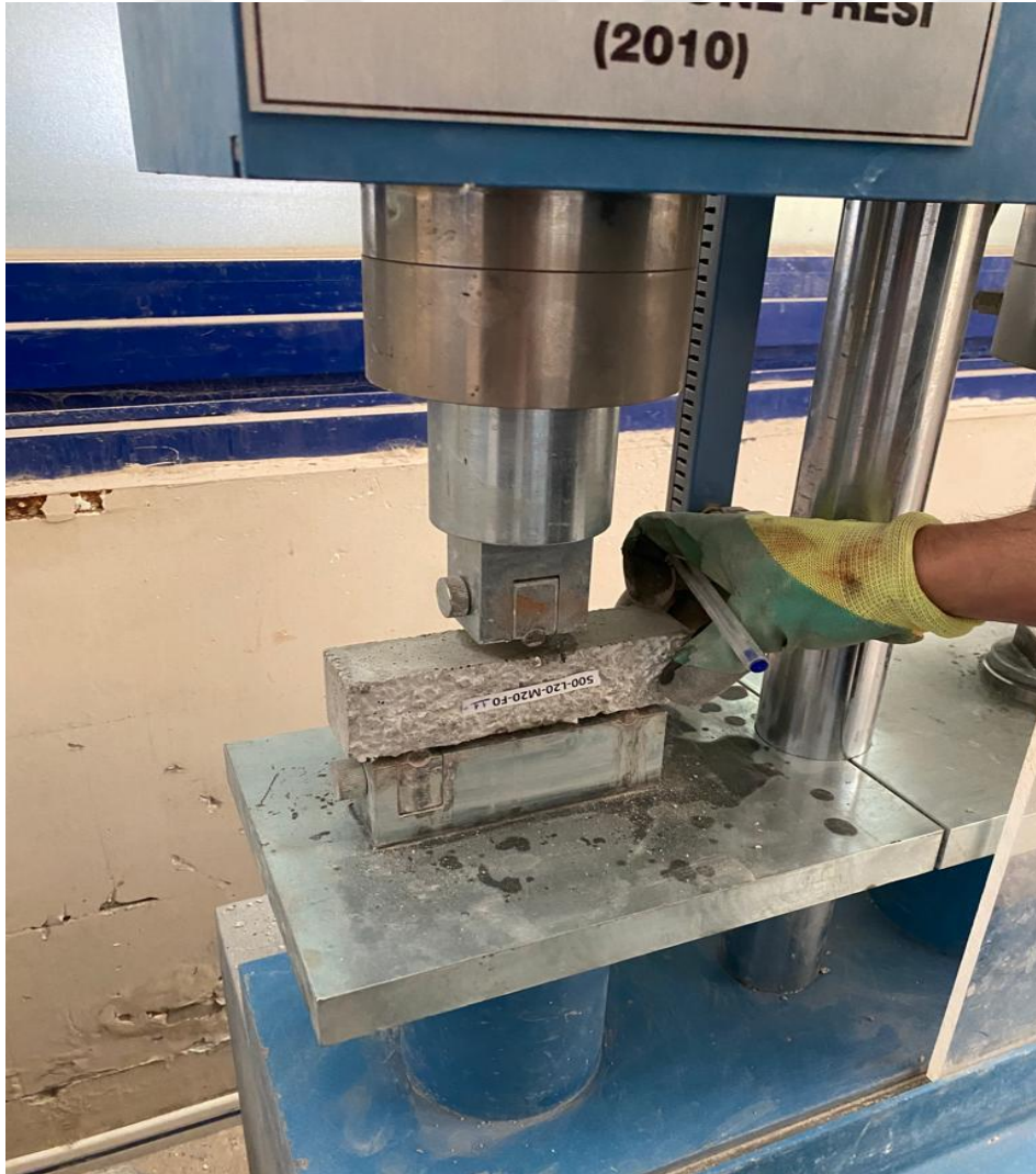
Şekil 3.10. Eğilme deneyi yapılışı ve deney düzeneği
