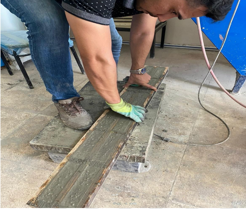
Şekil 3.7. Sarsma tablasına alınan harç kalıbı
