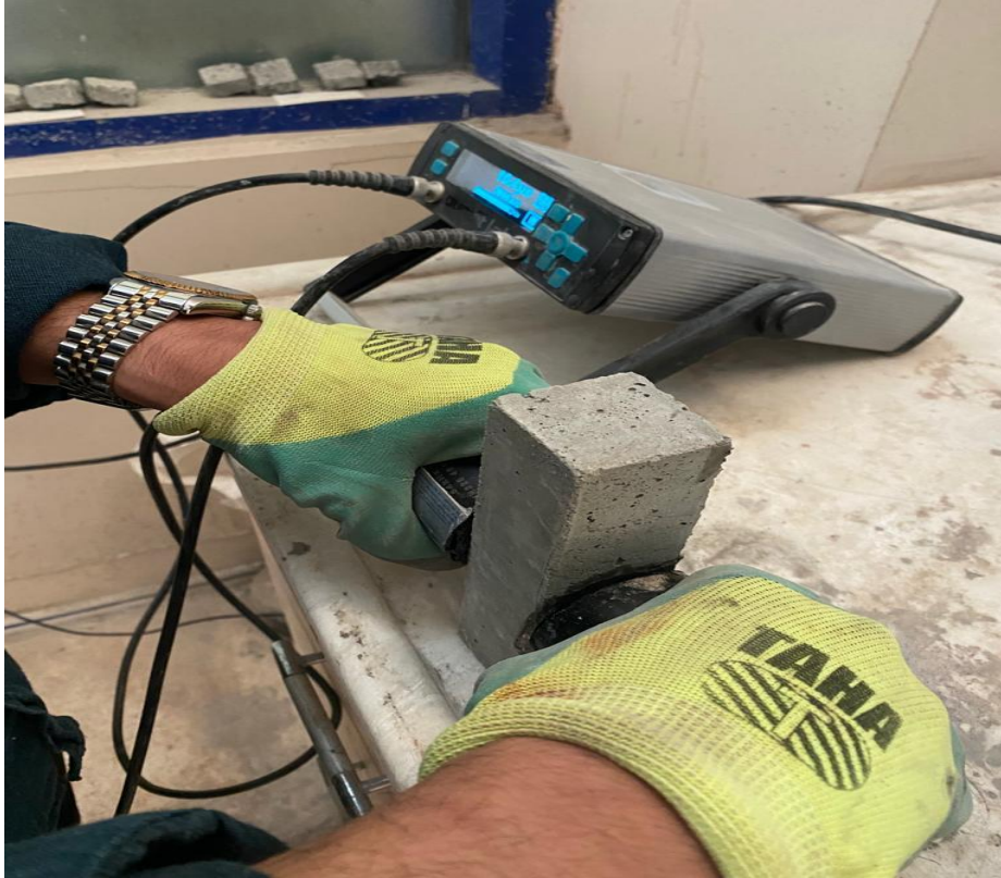
Şekil 3.9. Harç numunelerde UPV değerlerinin bulunması
