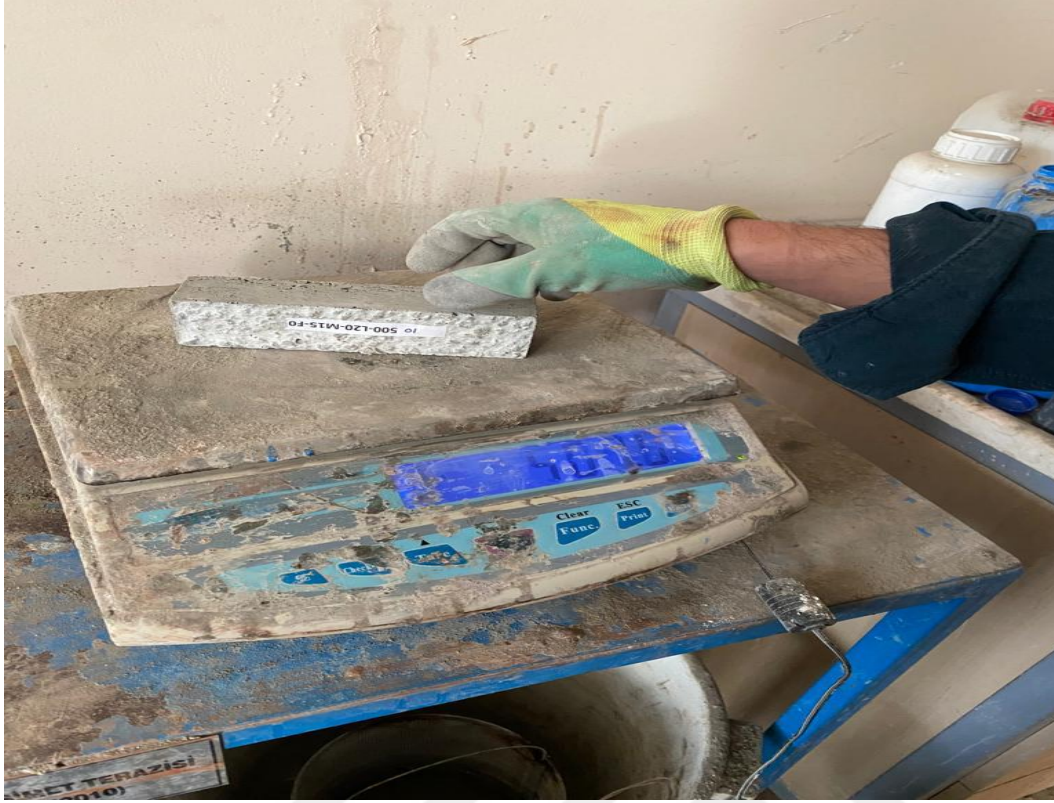
Şekil 3.8. Sertleşmiş harç numunelerin tartılması
