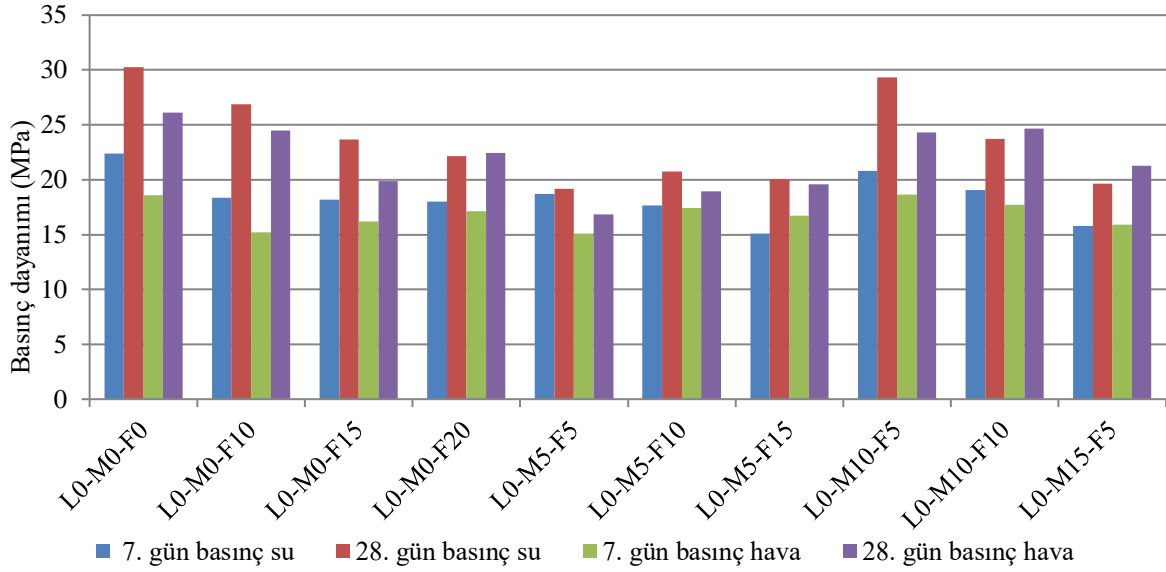
Şekil 4.35. L0 serisi EFC içeren numunelerin basınç dayanım grafiği
