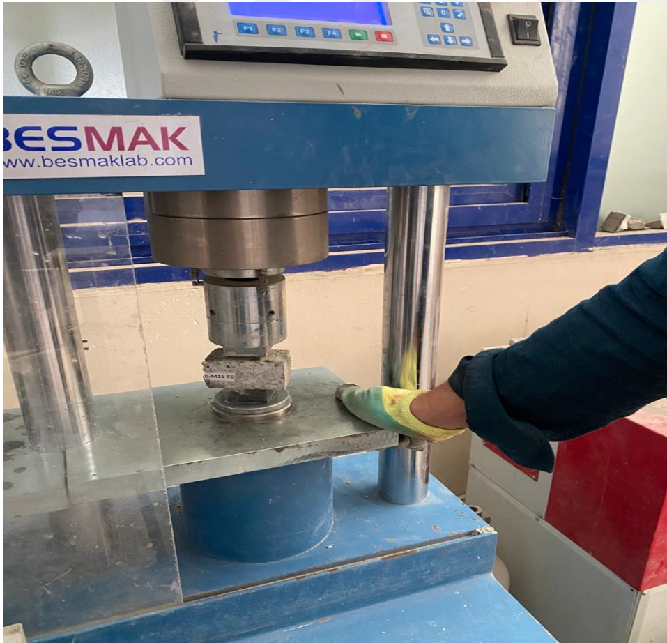
Şekil 3.11. Basınç deneyi yapılışı ve düzeneği
