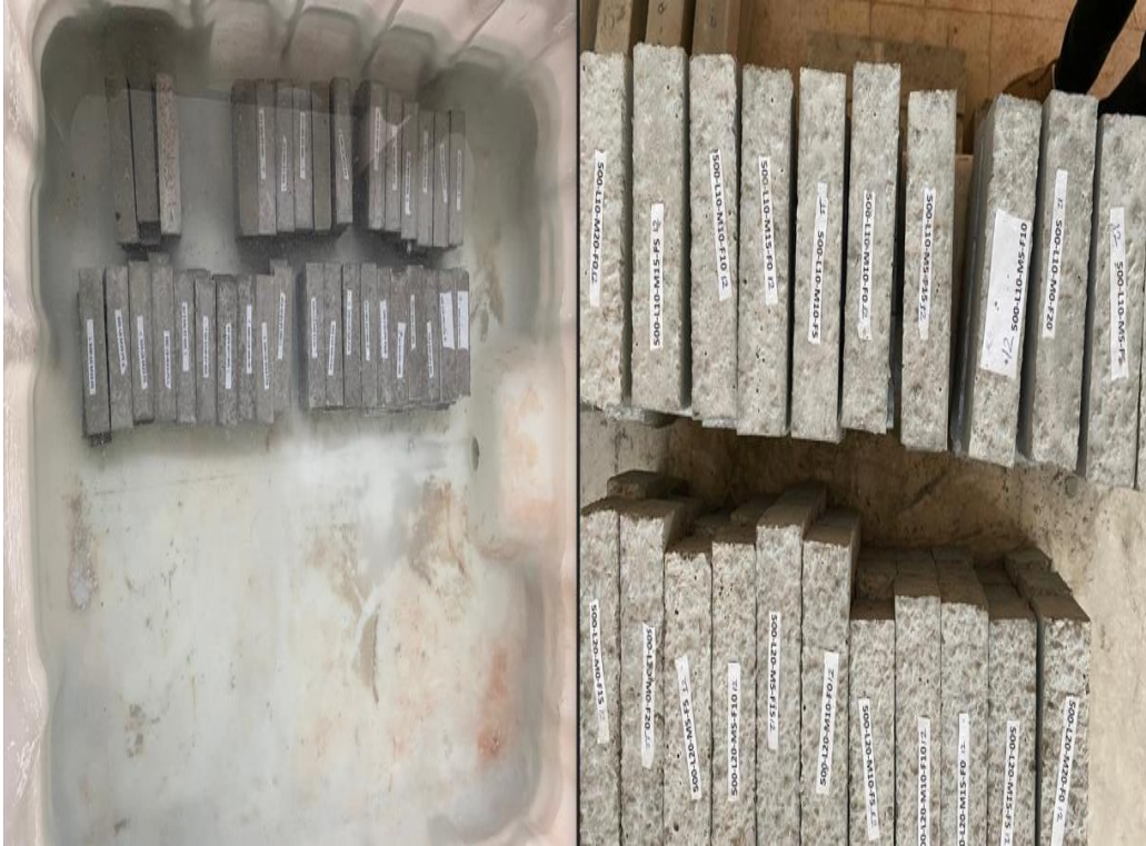
Şekil 3.8. Su ve hava küründe bekleyen numuneler
