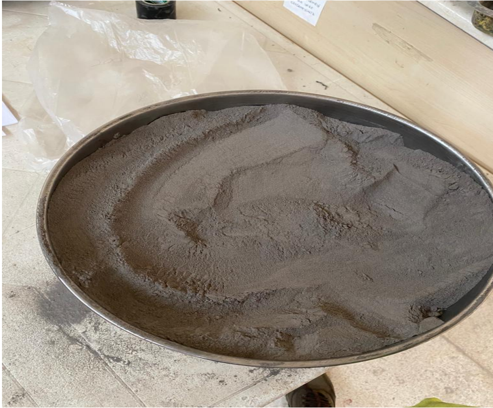
Şekil 3.2. Kullanılan EFC'nin elenmesi
