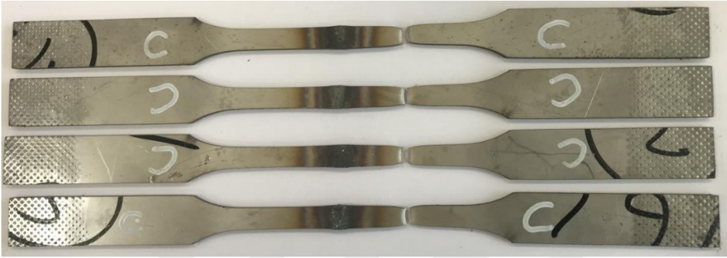
Şekil 4.34. Yüksek ısı girdili 316L-316L kaynaklı bağlantısından çıkarılan çekme numunelerinin test sonrası makro resimleri
