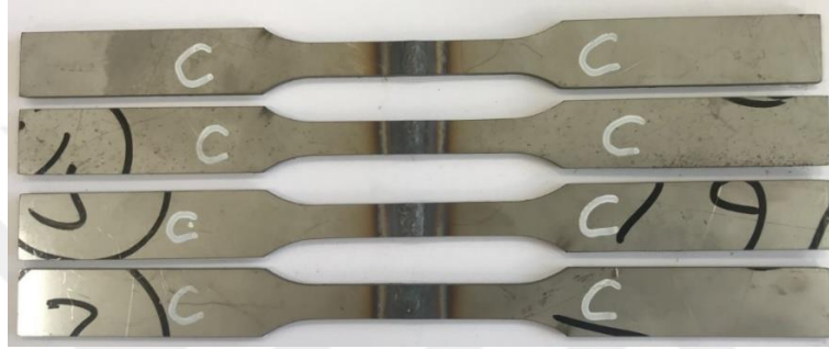
Şekil 3.12. Yüksek ısı girdisi ile GTAK yöntemiyle birleştirilen AISI 316L kaynaklı bağlantısından çıkarılan çekme testi numuneleri
