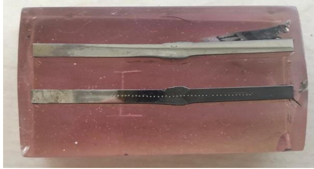
Şekil 3.7. Soğuk kalıba alınmış numune
