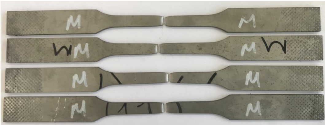
Şekil 4.35. AISI 318LN BM çekme numunelerinin test sonrası görünümü
