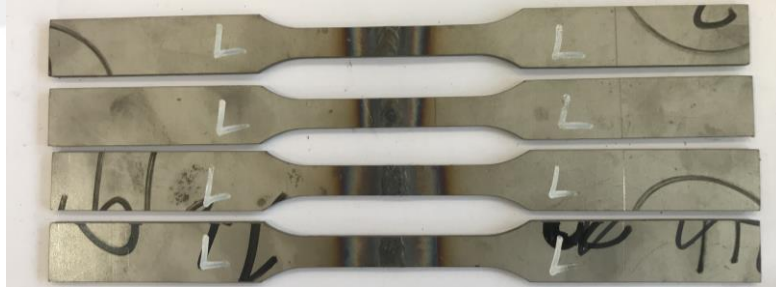
Şekil 3.16. Yüksek ısı girdisi ile GTAK yöntemiyle birleştirilen AISI 318LN kaynaklı bağlantısından çıkarılan çekme numuneleri
