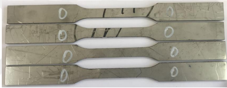
Şekil 3.9. AISI 316L baz plakasından çıkarılan çekme testi numuneleri
