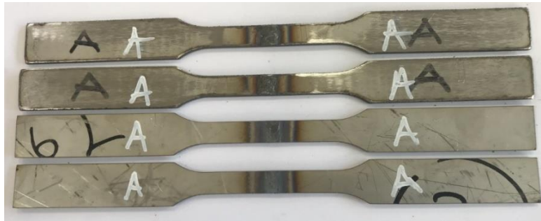
Şekil 3.10. Düşük ısı girdisi ile GTAK yöntemiyle birleştirilen AISI 316L kaynaklı bağlantısından çıkarılan çekme testi numuneleri
