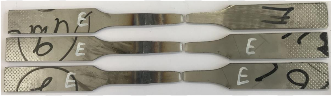
Şekil 4.40. ER309L ilave tel ile birleştirilen farklı 316L-318LN bağlantısından çıkarılan çekme numunelerinin test sonrası makro resimleri
