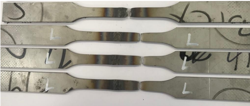
Şekil 4.38. Yüksek ısı girdili 318LN-318LN bağlantısından çıkarılan çekme numunelerinin test sonrası makro resimleri
