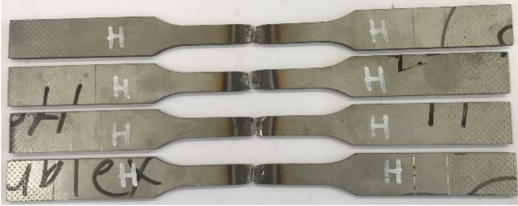
Şekil 4.36. Düşük ısı girdili 318LN-318LN bağlantısından çıkarılan çekme numunelerinin test sonrası makro resimleri
