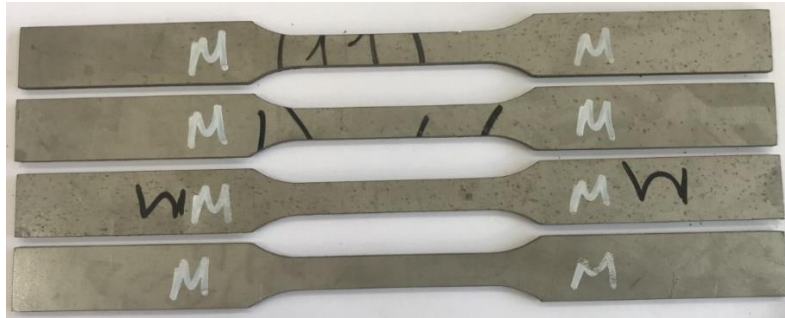
Şekil 3.13. AISI 318LN baz plakasından çıkarılan çekme testi numuneleri
