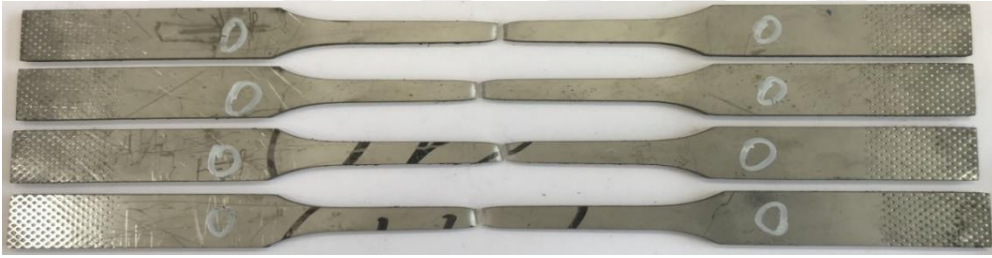
Şekil 4.31. AISI 316L BM çekme numunelerinin test sonrası görünümü
