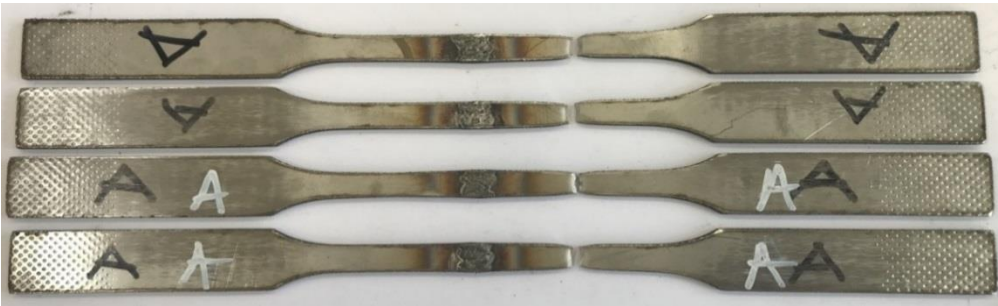
Şekil 4.32. Düşük ısı girdili 316L-316L kaynaklı bağlantısından çıkarılan çekme numunelerinin test sonrası makro resimleri
