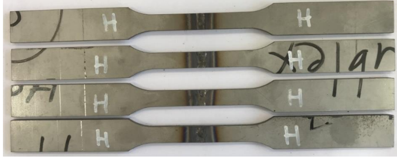
Şekil 3.14. Düşük ısı girdisi ile GTAK yöntemiyle birleştirilen AISI 318L kaynaklı bağlantısından çıkarılan çekme testi numuneleri
