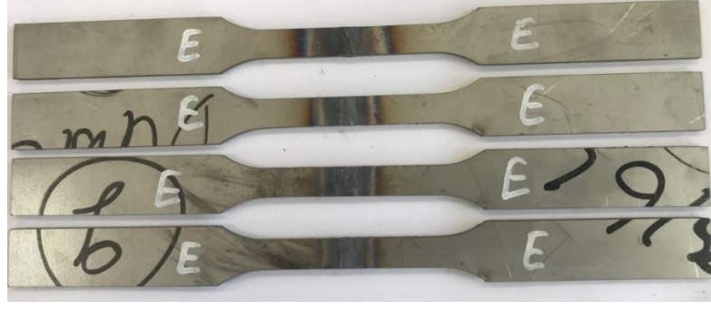
Şekil 3.18. ER309L ilave teli kullanılarak GTAK yöntemiyle birleştirilen AISI 316L -AISI 318LN kaynaklı bağlantısından çıkarılan çekme testi numuneleri
