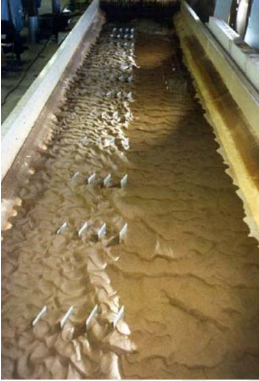
Şekil 1.16. Odgaard(2009) yaptığı deneyler ve batık kanat etrafında oluşan sirkülasyonlar
