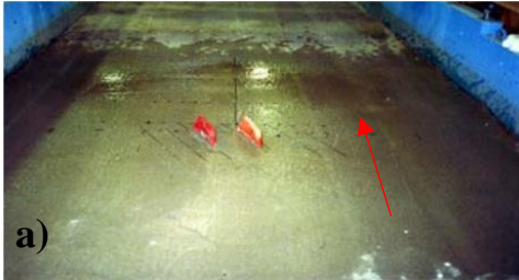
Şekil 1.16. Odgaard(2009) yaptığı deneyler ve batık kanat etrafında oluşan sirkülasyonlar
