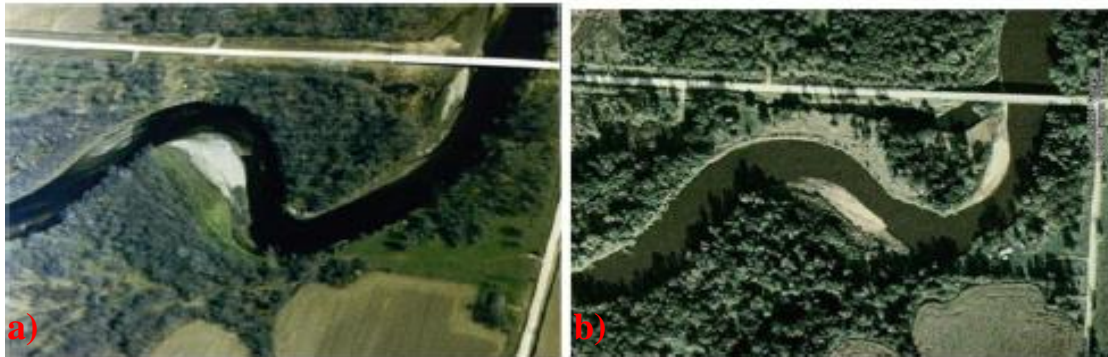
Şekil 1.11. Wapsipinicon Nehri batık kanat uygulamasından önce 1988 yılı (a) ve batık kanat sonrası, 2009 yıllarındaki (b) görüntüleri
