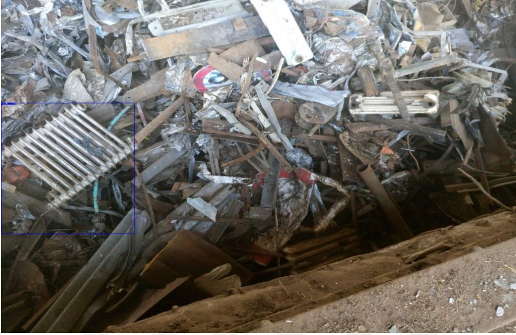
Resim 4.9. Hurda yığını içerisinde pycharm ile kalorifer peteklerinin tespiti
