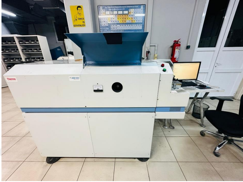
Resim 4.6 Thermo Fisher optik emisyon cihazı
