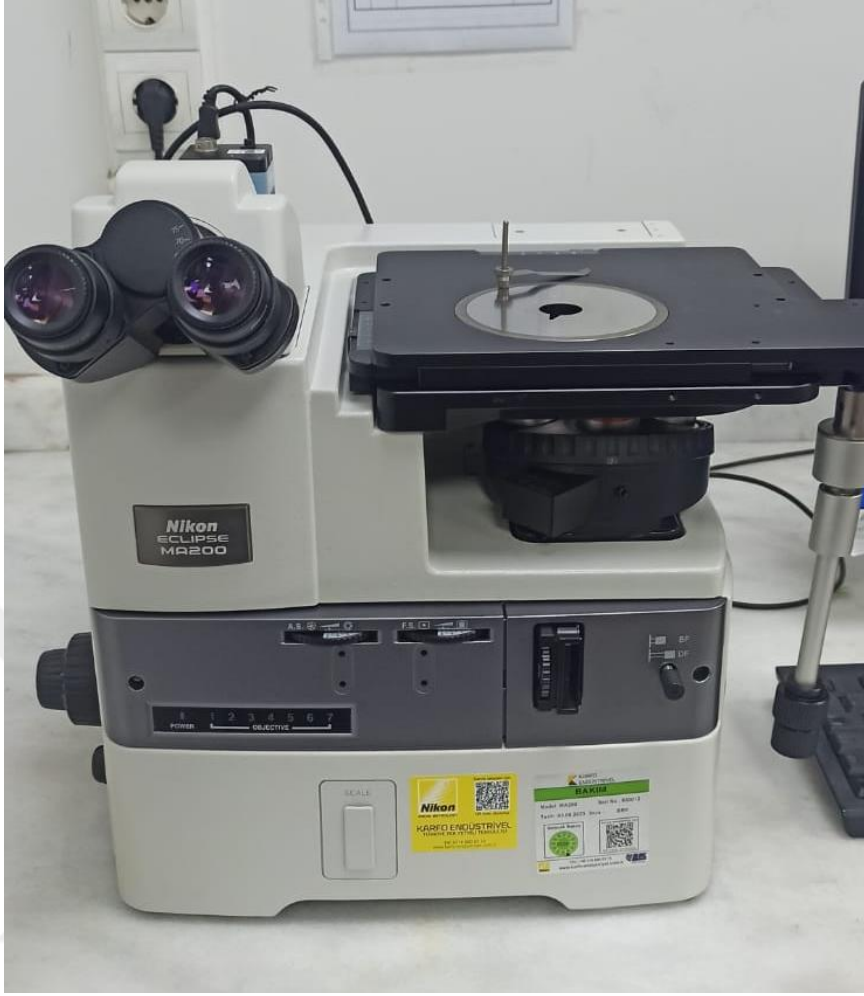
Resim 4.8. Nikon Eclipse MA200 ters metal mikroskobu
