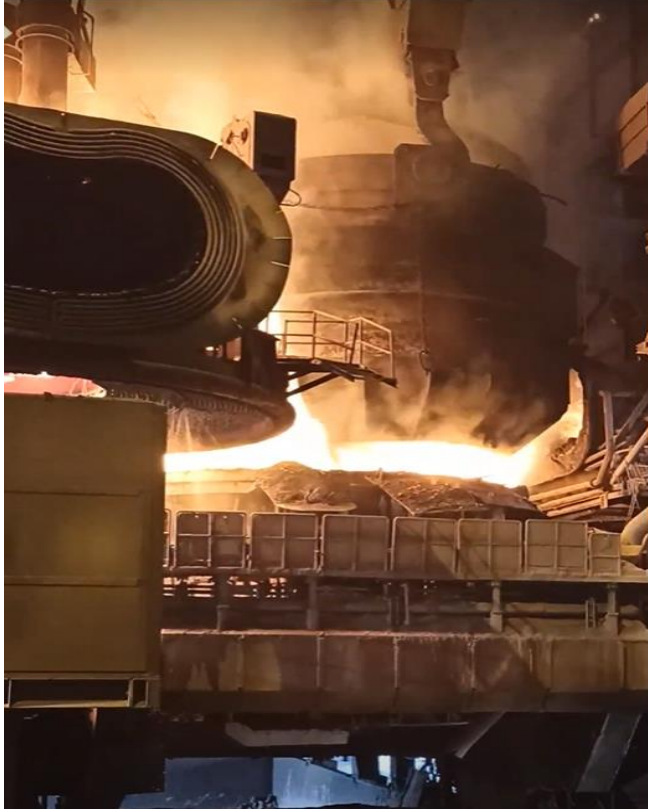
Resim 2.2 Elektrik ark ocağı şarj alma anı
