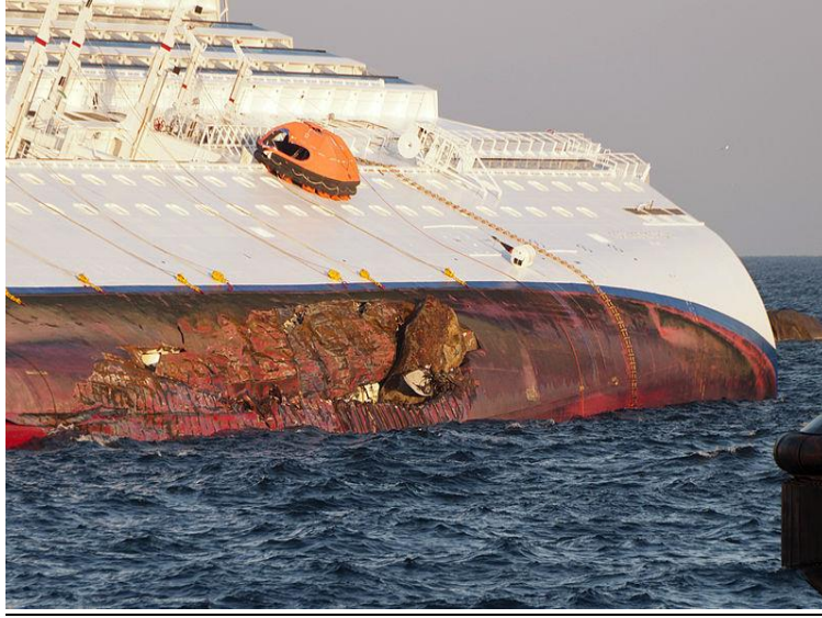
Resim 2.5. Costa concordia yolcu gemisinin karıştığı kazada karina hasarı alarak kısmen batması ve yatması (Kaynak: www.commons.wikimedia.org/ )
