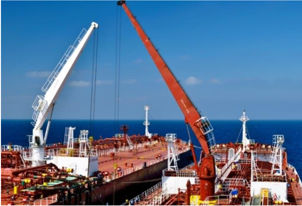
Resim 2.4. Gemiden gemiye transfer operasyonu (STS) (Kaynak:www.marineinsight.com).
