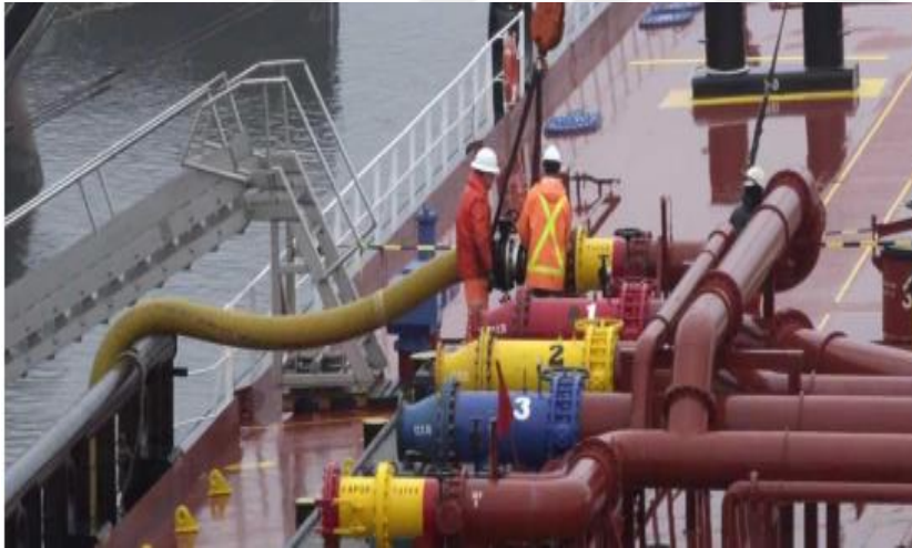
Resim 2.2. Kimyasal tankerlerde yükleme (Kaynak: Tanker temel eğitimleri,2017).
