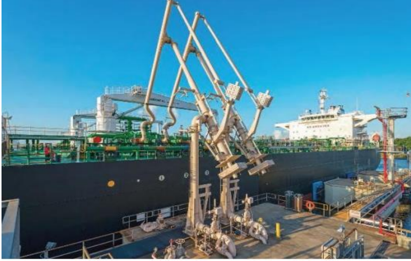
Resim 2.3.Kimyasal tankerlerde tahliye (Kaynak: Tanker temel eğitimleri,2017).
