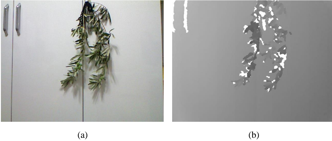
Resim 4.13 Kinect v1 kullanılarak uzak çekim ile elde edilen a) RGB görüntü b) derinlik görüntüsü
