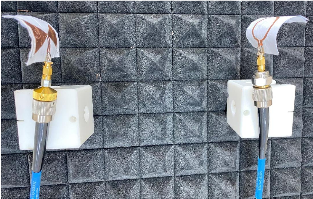
Şekil 4.44. Bowtie anten ile Dairesel Loop antenin dışbükeyken iletiminin testi
