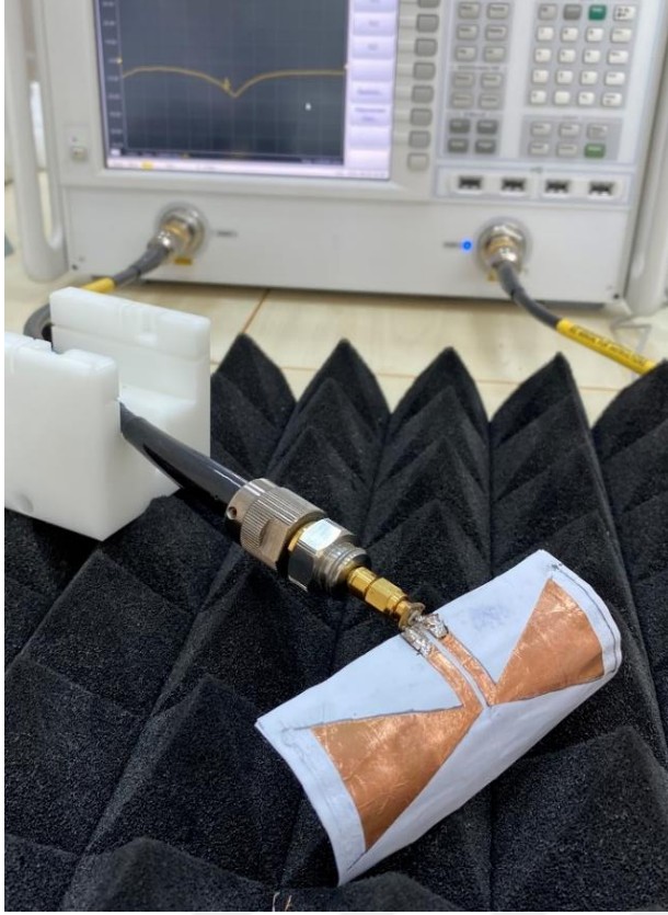
Şekil 4.41. Bowtie antenin dikey dış bükey halinin test aşaması
