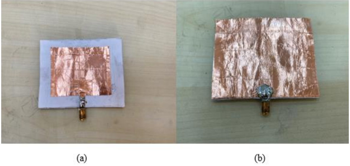
Şekil 4.7. Anten uygulaması (a) önden (b) arkadan
