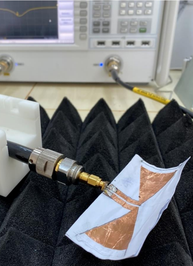
Şekil 4.40. Bowtie antenin dikey iç bükey halinin test aşaması
