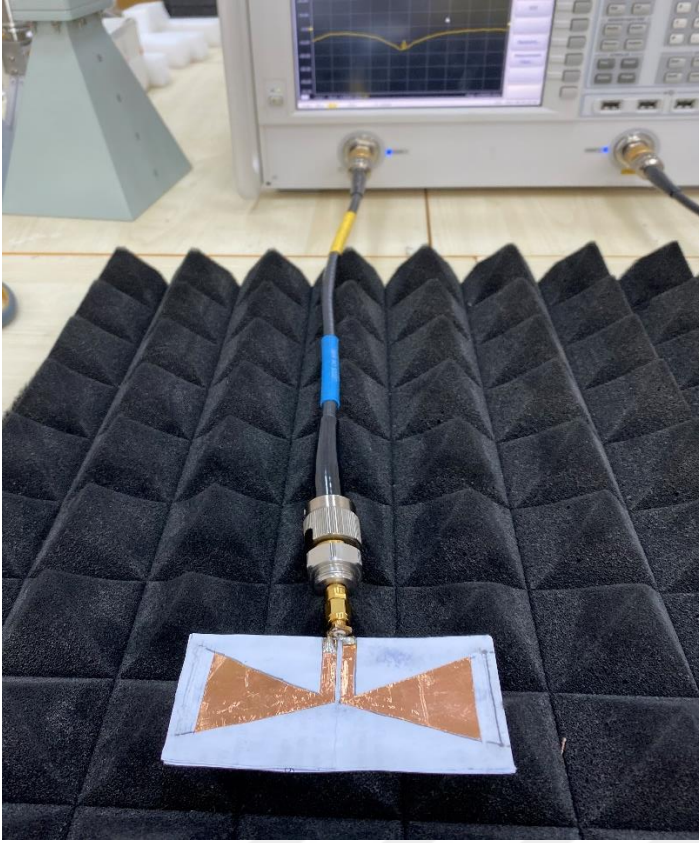
Şekil 4.37. Bowtie antenin düz halinin test aşaması
