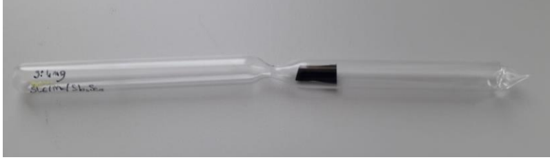
Resim 3.1. İçerisinde sülfür ve Sb_2Se_3 bulunan kapatılmış kuvars ampulün resmi
