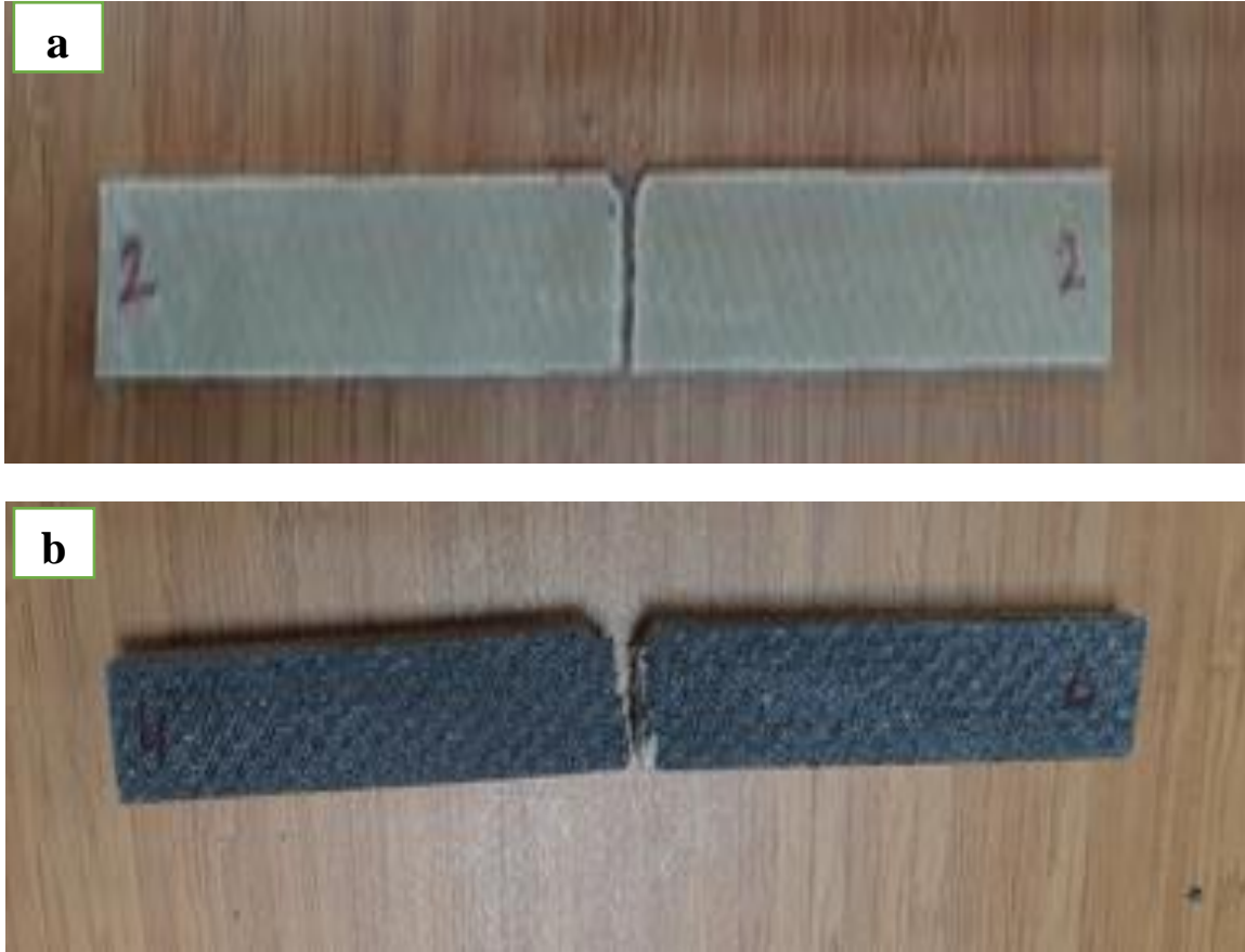
Resim 4.3. Çentik darbe (Charpy) testi sonunda çentik noktalarından kırılan numuneler (a) 12P (b) 3K24P3K
