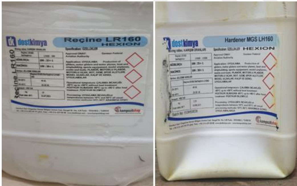
Resim 3.3. Epoksi matrisi (a) Reçine (b) Sertleştirici
