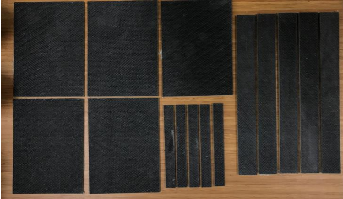
Resim 3.6. ASTM standartlarına göre kesilmiş numuneler
