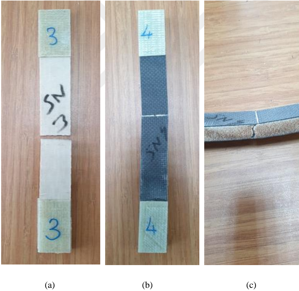
Resim 4.1. Çekme testi sonunda kopmuş numuneler (a) 12P (b) 3K24P3K (c) 3K24P3K yandan görünümü
