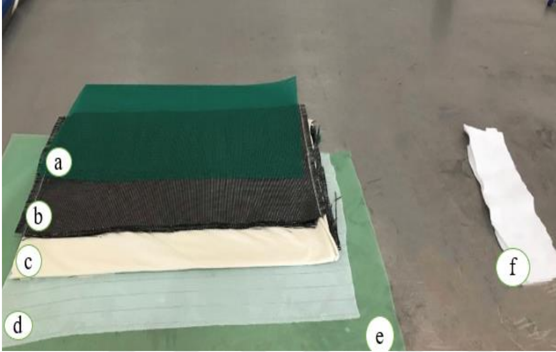
Resim 3.4. Kompozit üretiminde kullanılan malzemeler (a) infüzyon filesi, (b) karbon elyaf kumaş, (c) pamuk elyaf kumaş, (d) soyma kumaşı, (e) vakum torbası, (f) vakum battaniyesi
