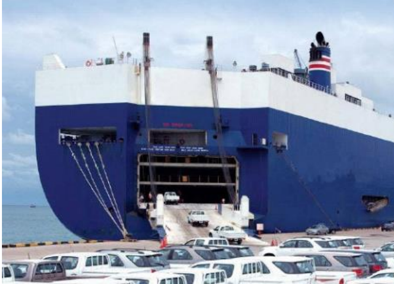
Resim 2.2. Kıçtan rampalı bir Ro-Ro gemi örneği
