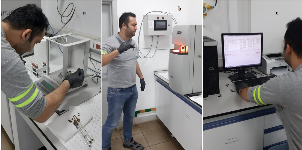
Resim 3.7. Ölçüm aşamaları, (a) numune tartımı, (b) yüksek sıcaklıkta yakma, (c) kükürt ölçümü
