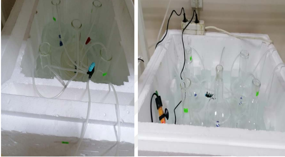
Resim 3.8. 28 °C sıcaklığı sabit tutmak için su banyosunda kullanılan termostatlı su ısıtıcısı (Orijinal)
