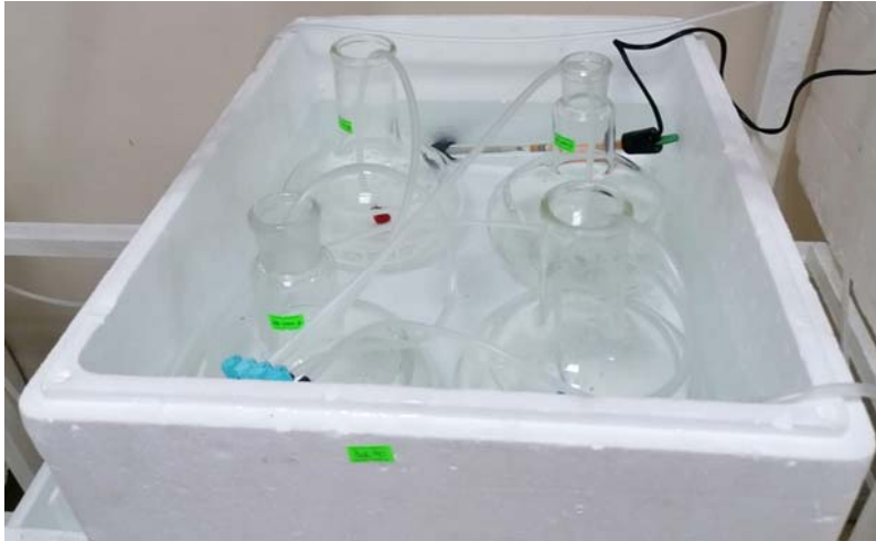
Resim 3. 9. 32 °C Sıcaklığı sabit tutmak için su banyosunda kullanılan termostatlı ısıtıcısı (Orijinal)
