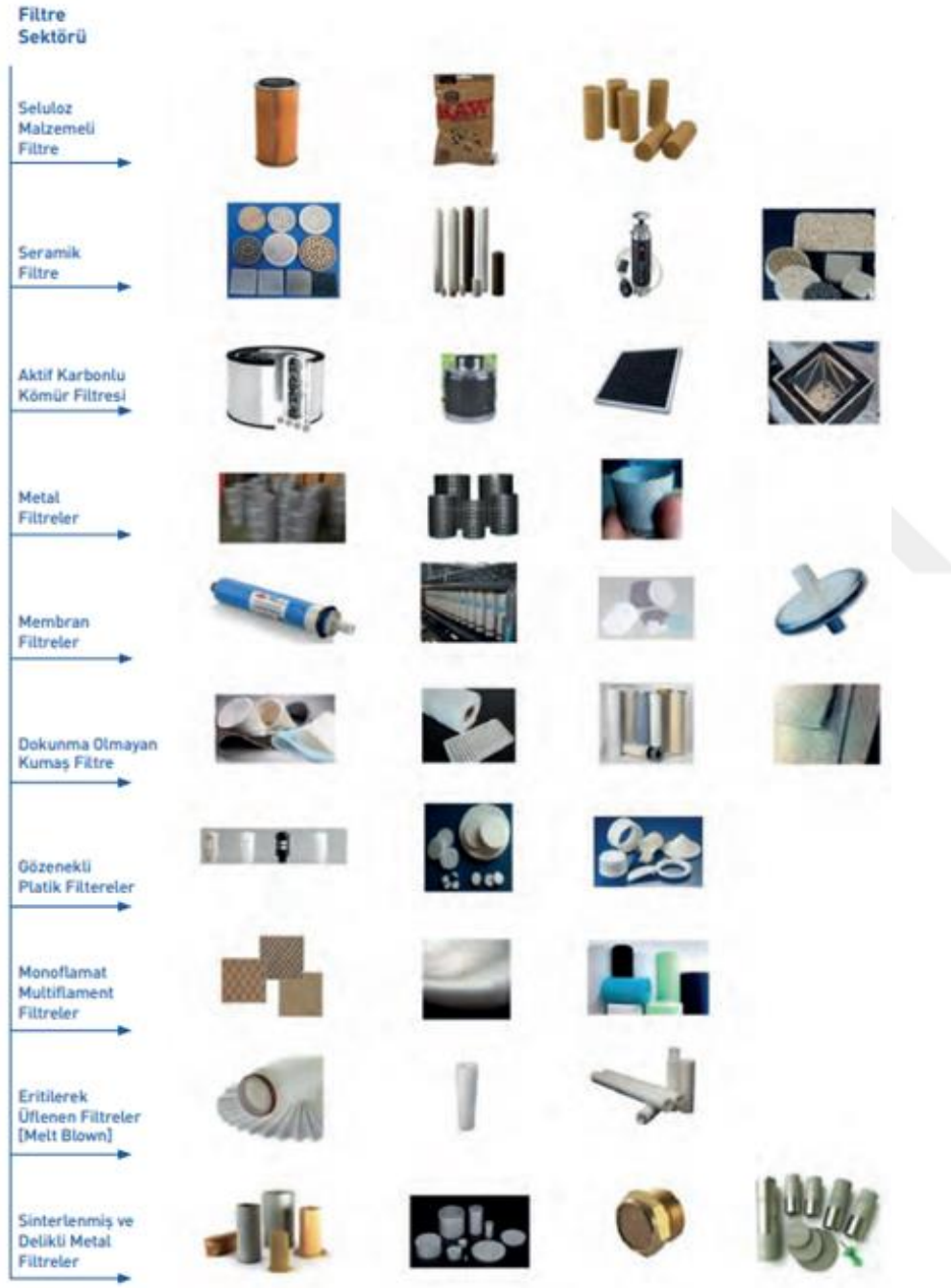
Şekil 3.2 Kullanılan malzeme çeşidine göre filtre ürün grupları [55]
