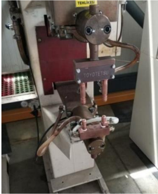
Şekil 2.5. Tasarımı yapılan çoklu nokta elektrotu
