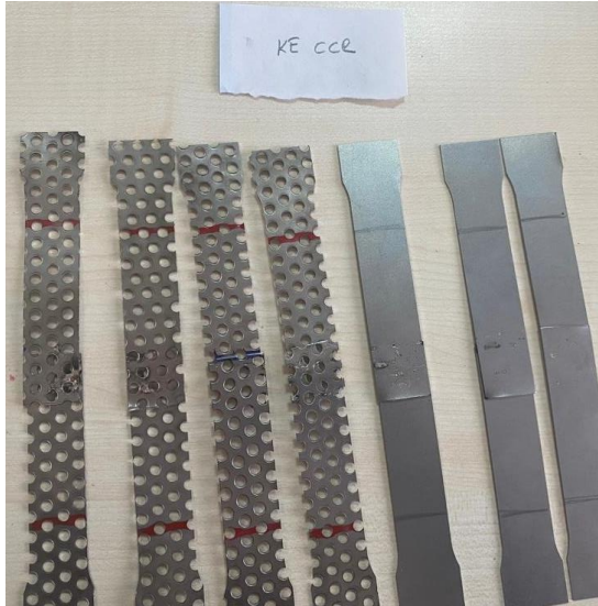
Şekil 4.5 Düz ve Delikli Nokta direnç kaynak kaynaklı çekme test numunesi
