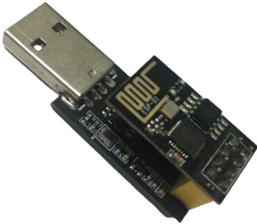
Şekil 4.2. ESP-01 kullanılarak tasarlanan kablosuz alıcı modül.
