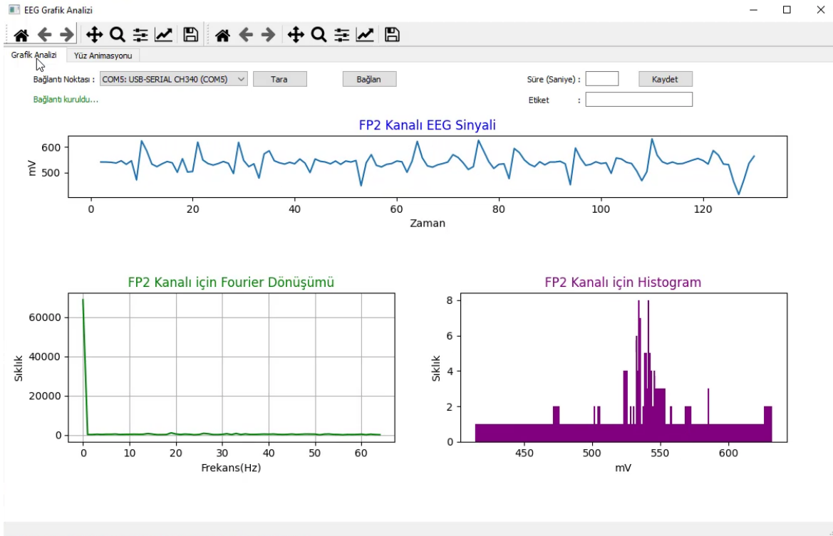
Şekil 4.4. Taşınabilir EEG kayıt cihazı için tasarlanan kullanıcı arayüzü.
