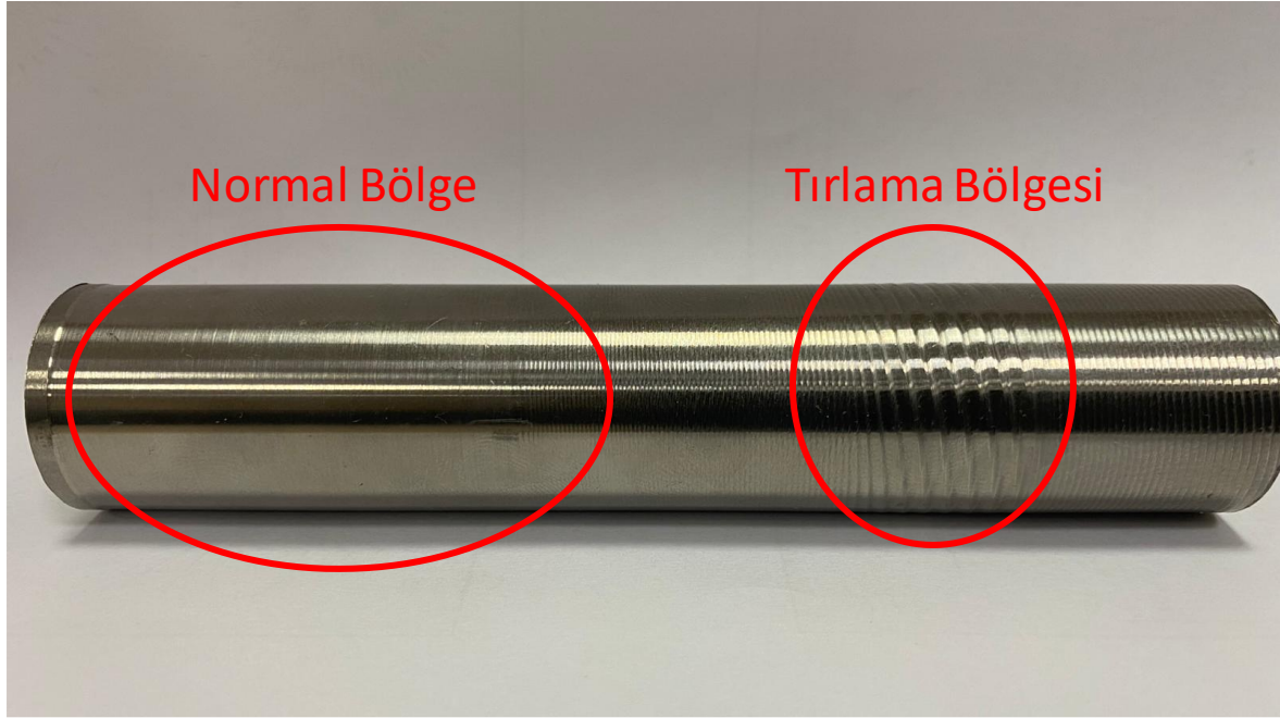
Şekil 4.30. Ti6Al4V iş parçası için tornalama sonrası görüntü
