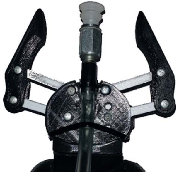
Şekil 11. Vakum tutucu modeli (Vacuum gripper model)
