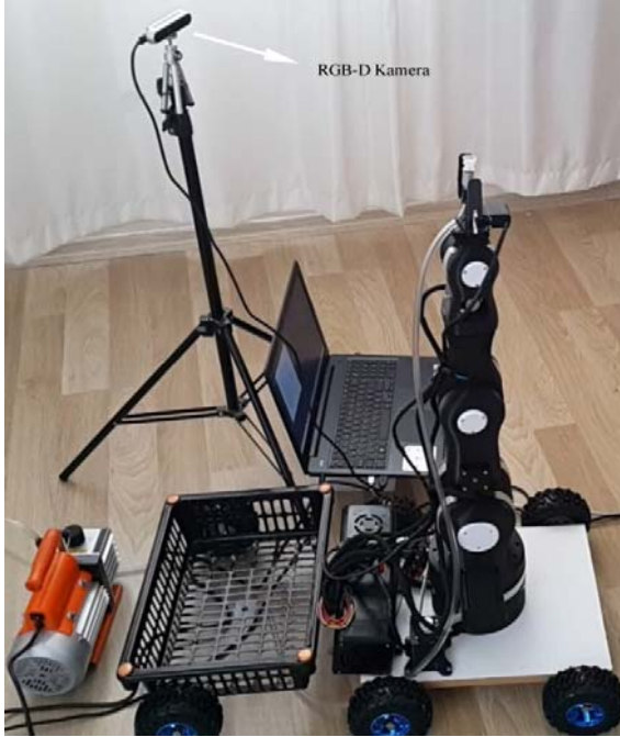
Şekil 13. RGB-D kamera konumu (RGB-D camera location)
